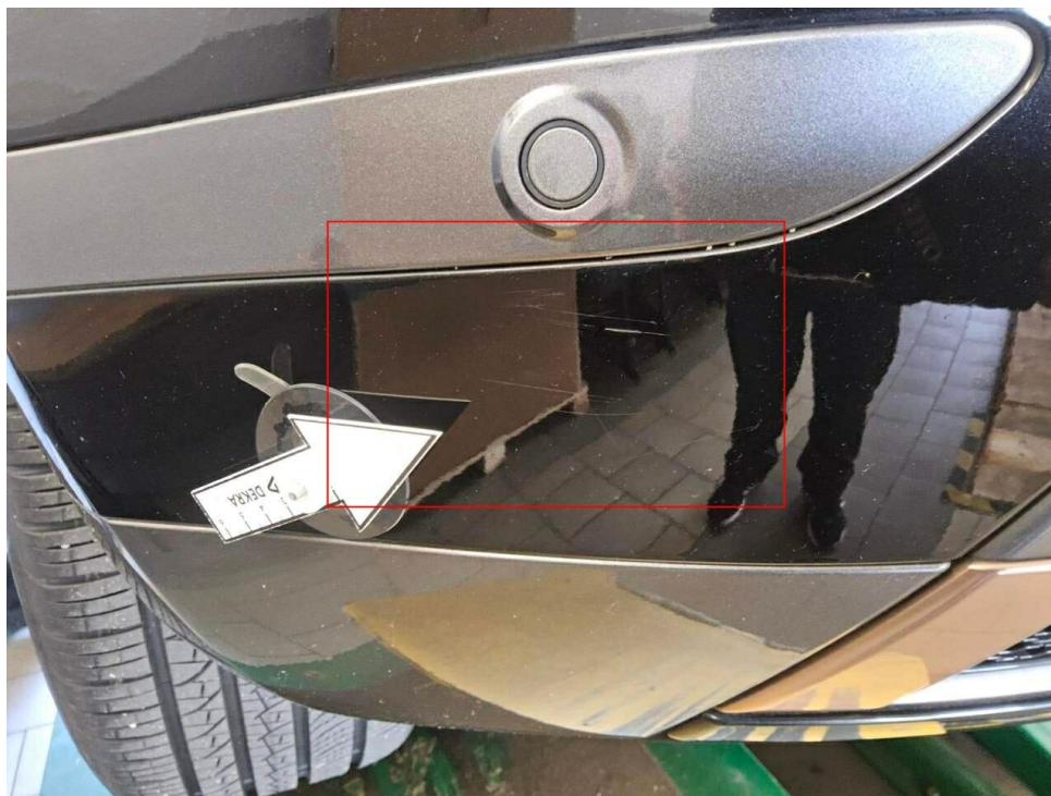
Bild 15 : Stoßfänger hinten Lackierung, verschrammt, lackieren mit Lackaufbau
