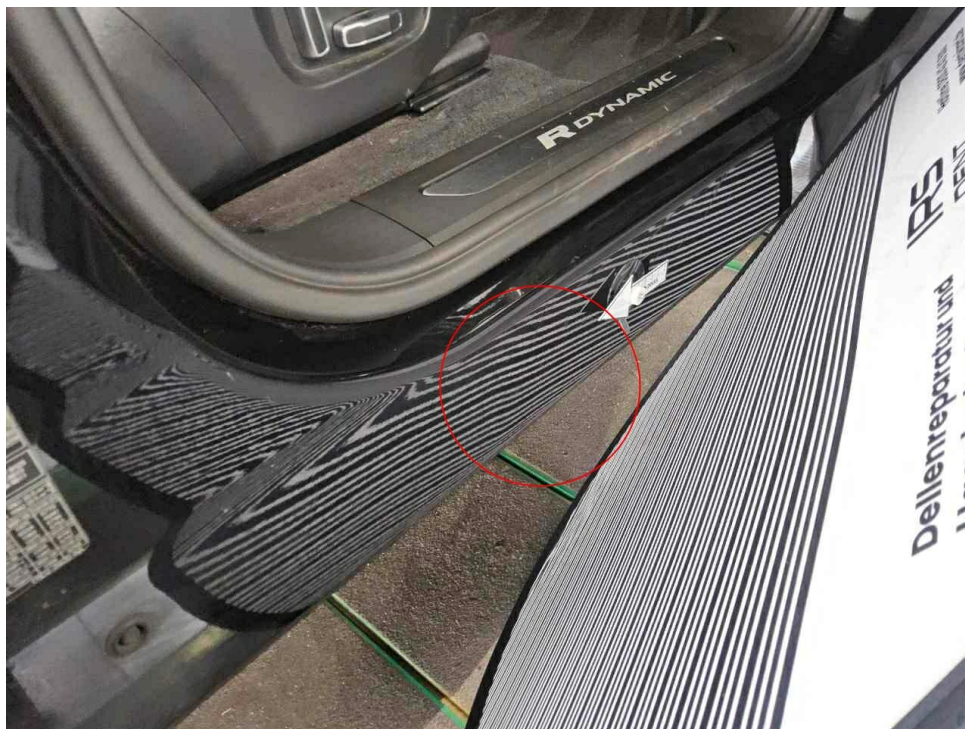
Bild 20 : Seitenschweller rechts, deformiert, drücken
