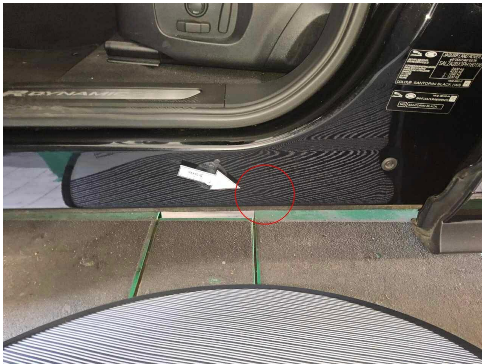
Bild 12 : Seitenschweller links, deformiert, drücken
