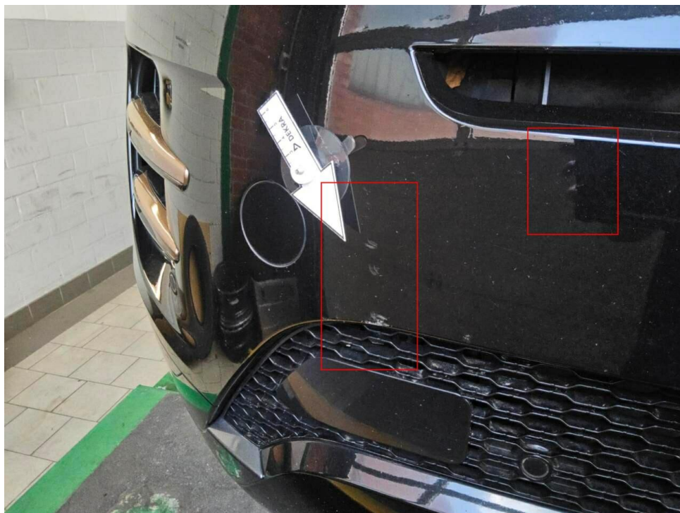
Bild 25 : Stoßfänger vorne Lackierung, verschrammt, lackieren mit Lackaufbau
