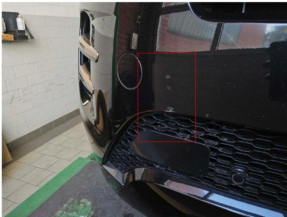
Bild 28 : Stoßfänger vorne verschrammt
