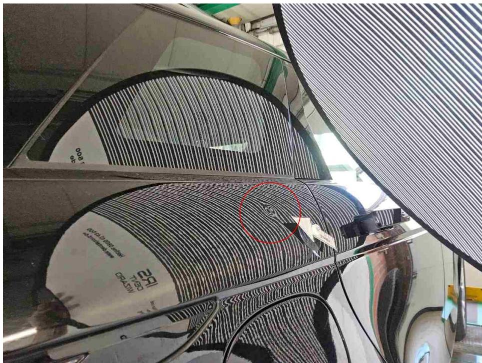
Bild 19 : Seitenteil hinten rechts, deformiert, drücken
