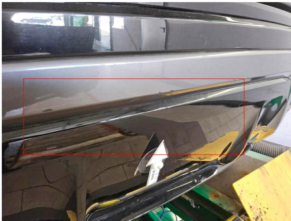
Bild 17 : Heckschürze hinten unten Lackierung, verschrammt, lackieren mit Lackaufbau
