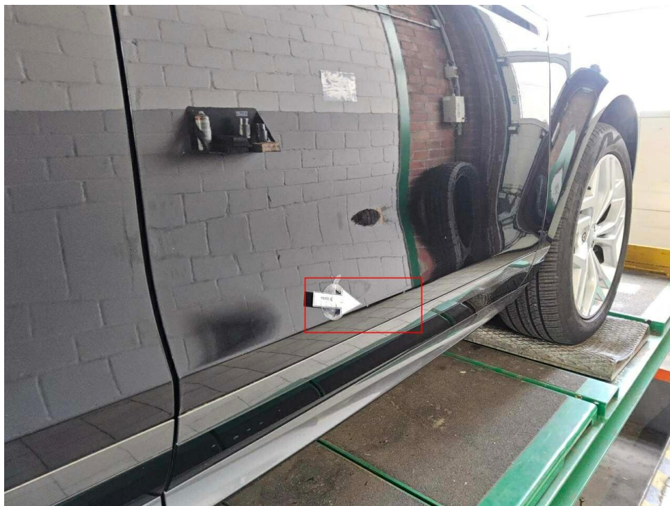
Bild 22 : Tür vorne rechts Lackierung, verschrammt, smart repair
