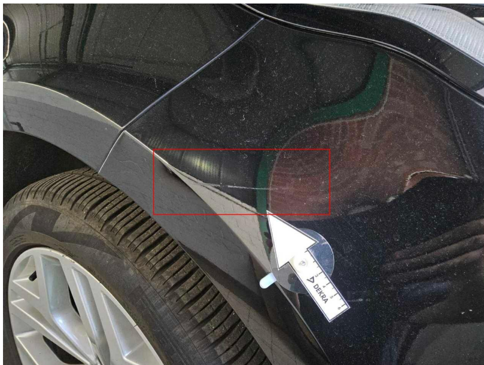
Bild 24 : Stoßfänger vorne Lackierung, verschrammt, lackieren mit Lackaufbau
