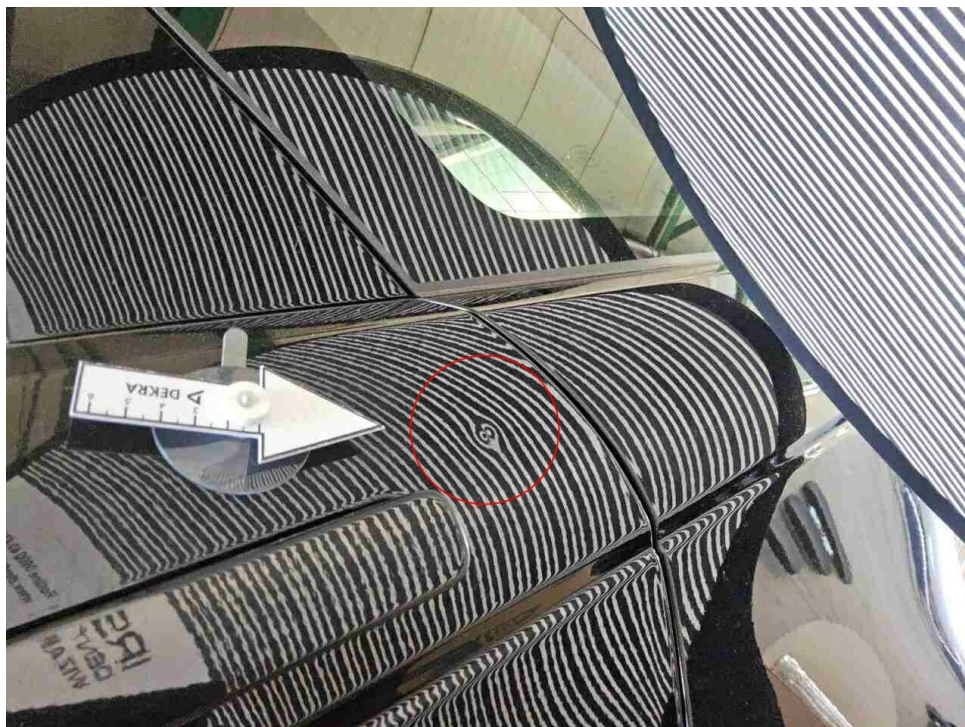
Bild 13 : Tür hinten links, deformiert, drücken
