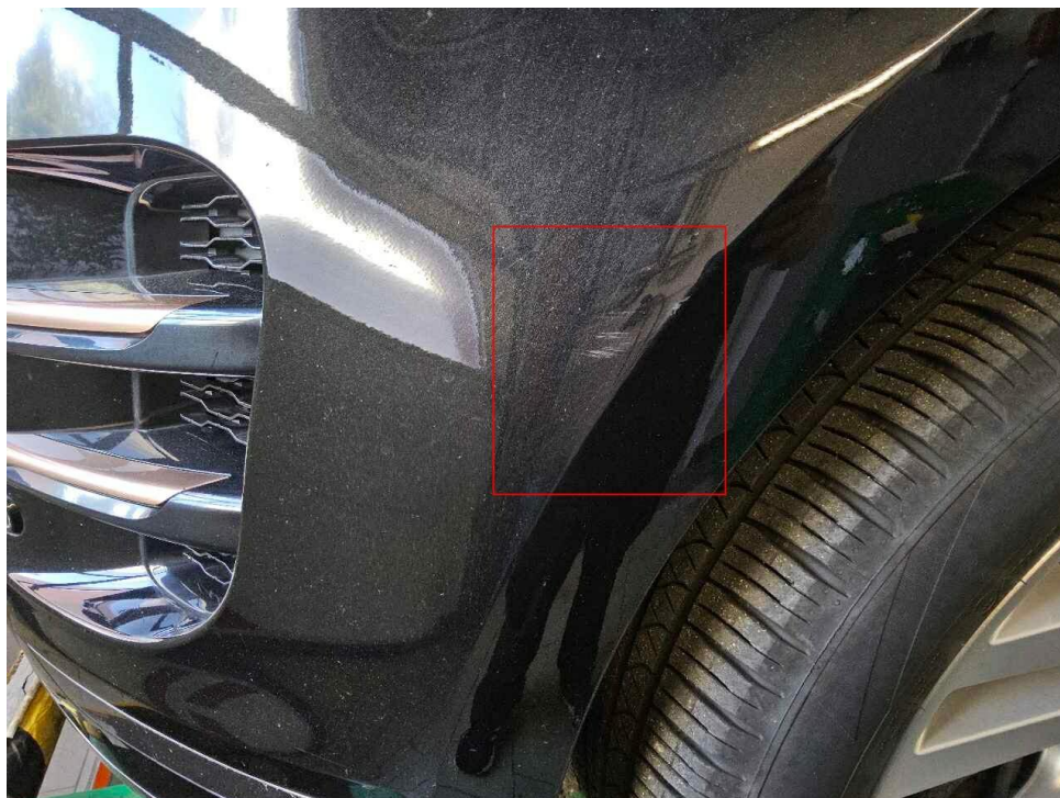
Bild 27 : Stoßfänger vorne verschrammt
