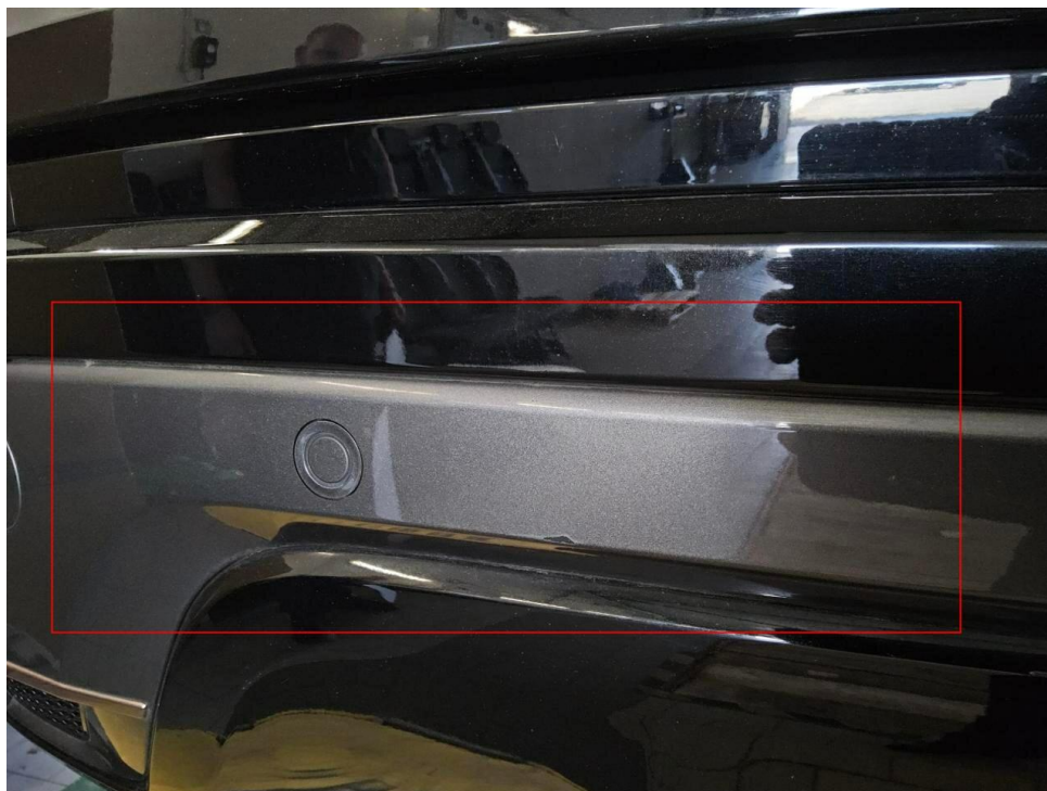
Bild 16 : Stoßfänger hinten Lackierung, verschrammt, lackieren mit Lackaufbau
