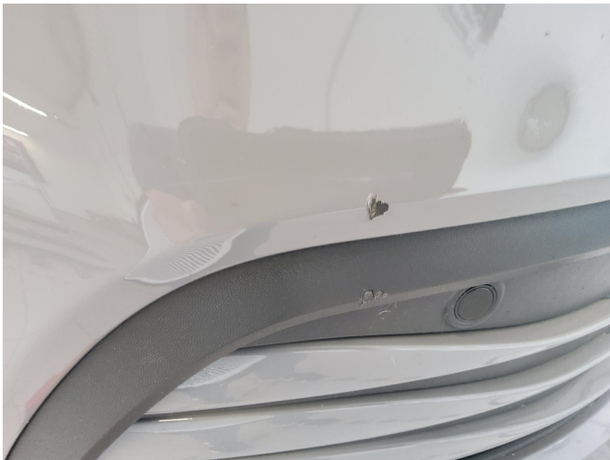
Bild 19: Außen, Stoßfänger vorne - Lackierung, verschrämmt, lackieren mit Lackaufbau
