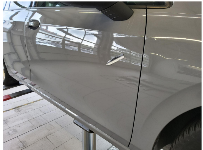
Bild 14: Außen, Tür vorne rechts, eingedellt, drücken
