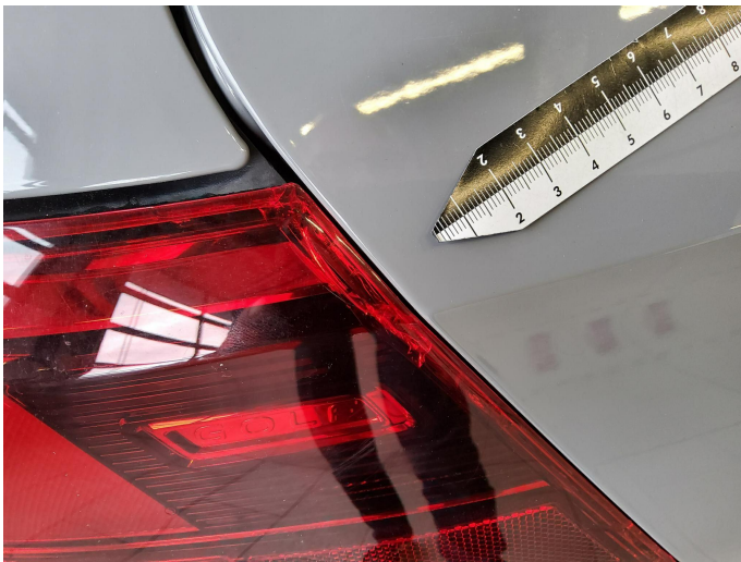
Bild 13: Außen, Rückleuchte rechts , gerissen, erneuern
