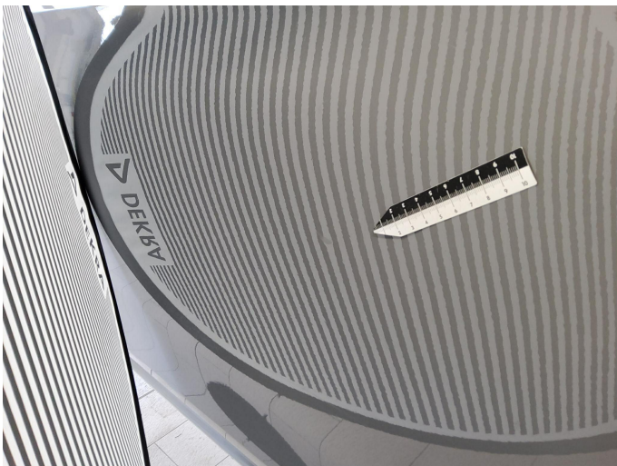
Bild 15: Außen, Tür vorne rechts, eingedellt, drücken
