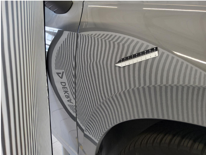
Bild 17: Außen, Kotflügel vorne rechts, eingedellt, drücken
