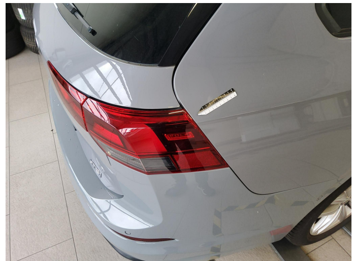
Bild 12: Außen, Rückleuchte rechts, gerissen, erneuern
