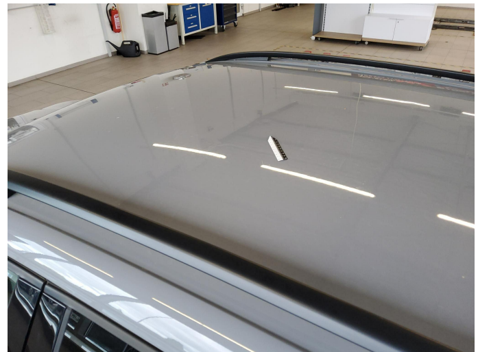
Bild 6: Außen, Dach, eingedellt, drücken
