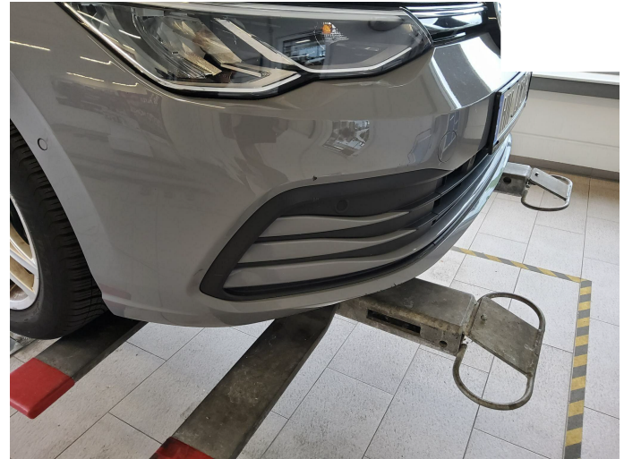
Bild 18: Außen, Stoßfänger vorne - Lackierung, verschrämmt, lackieren mit Lackaufbau
