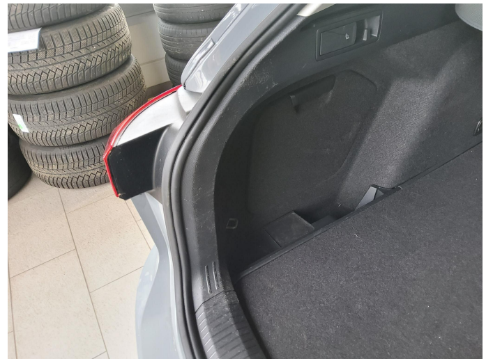
Bild 2: Innen, Verkleidung Kofferraum - hinten, verschrammt, erneuern
