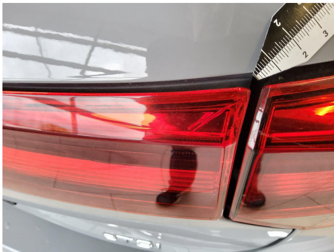
Bild 11: Außen, Rückleuchte rechts innen, gerissen, erneuern
