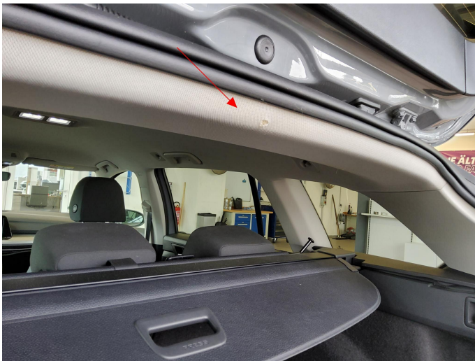
Bild 1: Innen, Dachhimmel, Loch, smart repair
