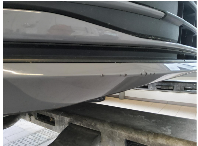
Bild 20: Außen, Stoßfänger vorne - Lackierung, verschrämmt, lackieren mit Lackaufbau
