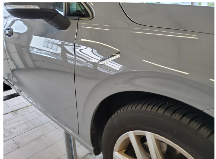
Bild 16: Außen, Kotflügel vorne rechts, eingedellt, drücken
