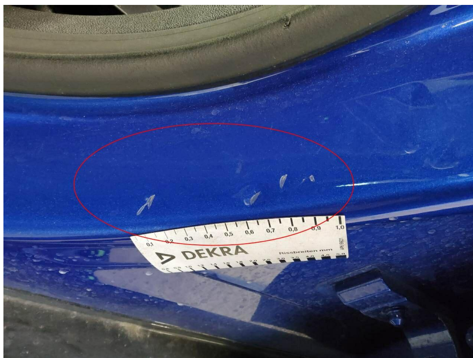
Bild 24 : Tür vorne links Einstieg, mehrfach eingedellt, instandsetzen und lackieren mit Lackaufbau
