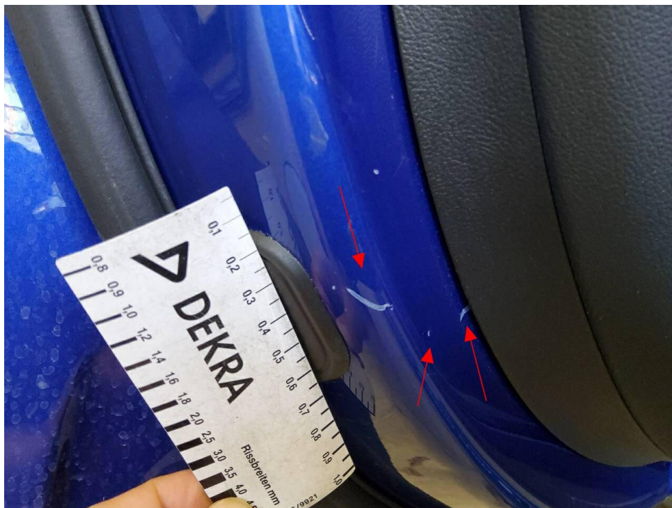
Bild 27 : Tür vorne links innen, eingedellt, verschrammt
