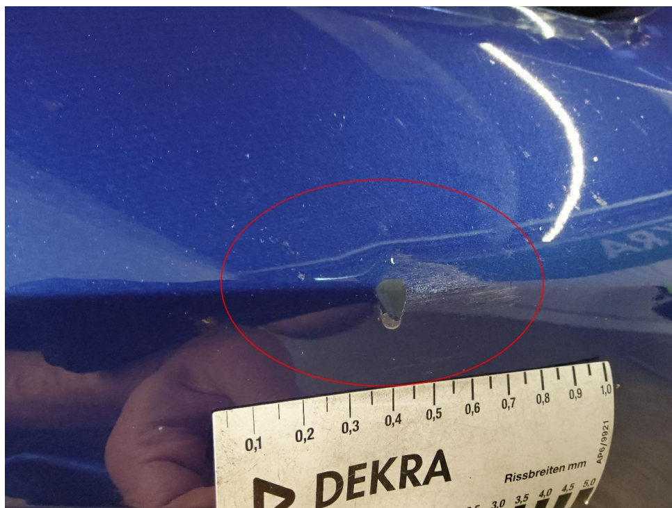
Bild 17 : Stoßfänger vorne, deformiert
