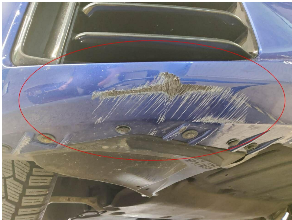
Bild 21 : Stoßfänger vorne, deformiert
