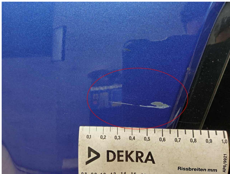
Bild 19 : Stoßfänger vorne, deformiert
