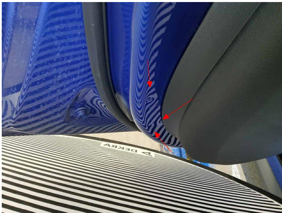
Bild 28 : Tür vorne links innen, eingedellt, verschrammt
