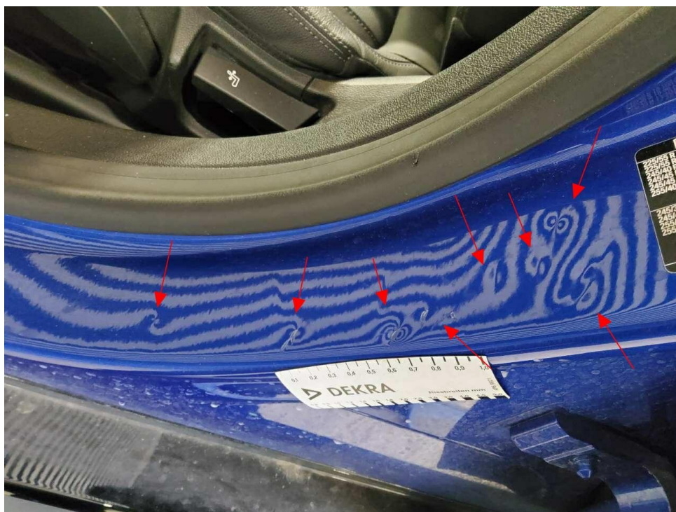
Bild 25 : Tür vorne links Einstieg, mehrfach eingedellt, instandsetzen und lackieren mit Lackaufbau
