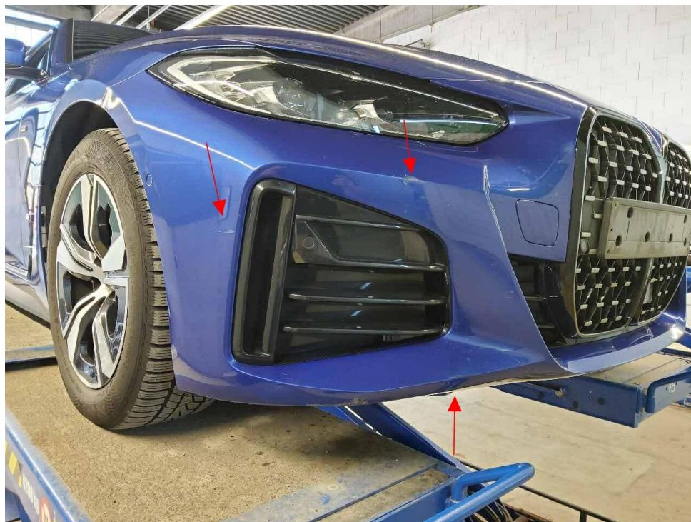
Bild 16 : Stoßfänger vorne, deformiert
