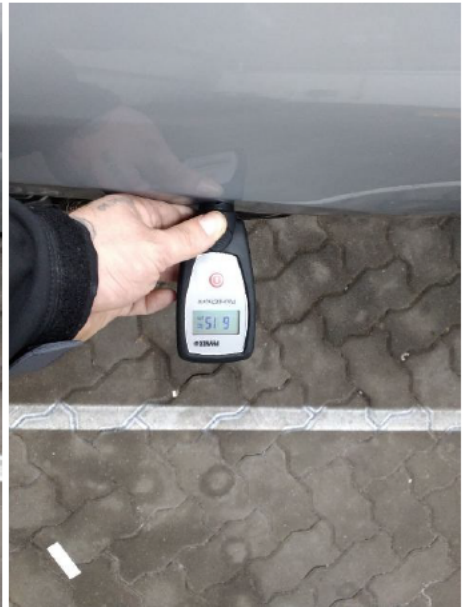
Kotflügel / Vorne Links / Schlecht Repariert
