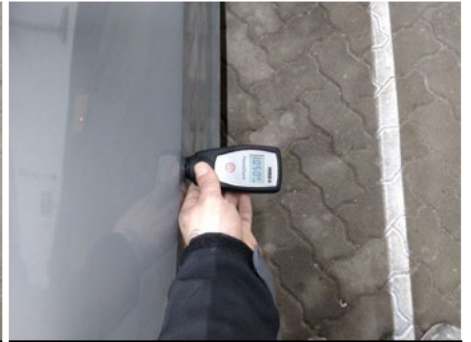
Tür / Vorne Links / Schlecht Repariert
