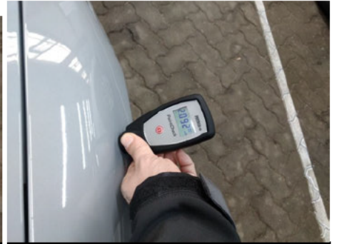
Kotflügel / Vorne Rechts / Schlecht Repariert
