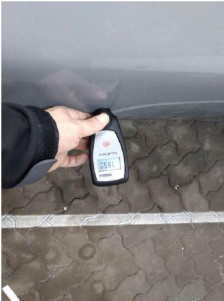
Kotflügel / Vorne Links / Schlecht Repariert
