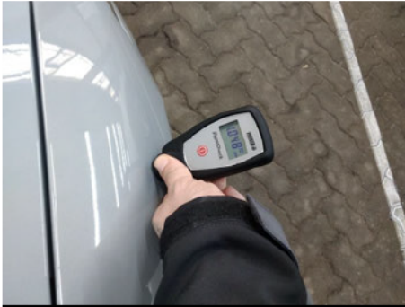
Kotflügel / Vorne Rechts / Schlecht Repariert
