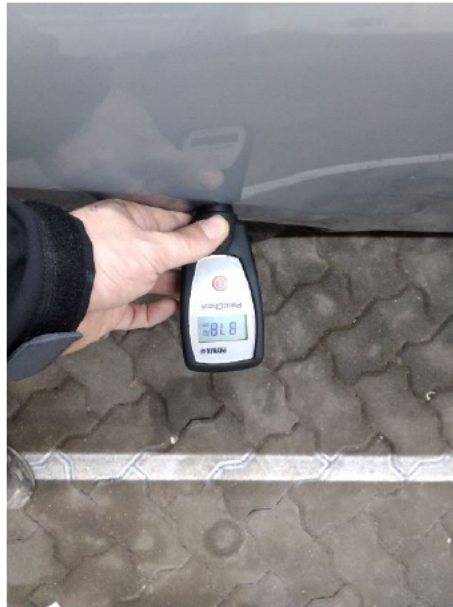
Kotflügel / Vorne Links / Schlecht Repariert
