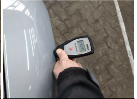
Kotflügel / Vorne Rechts / Schlecht Repariert
