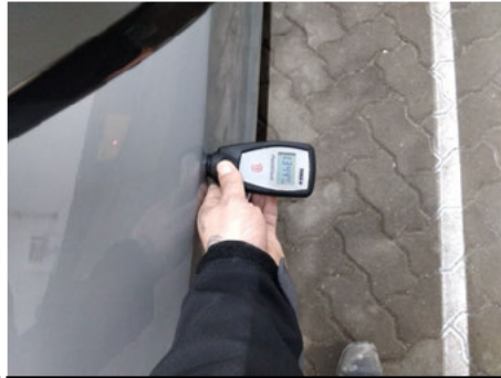
Tür / Vorne Links / Schlecht Repariert
