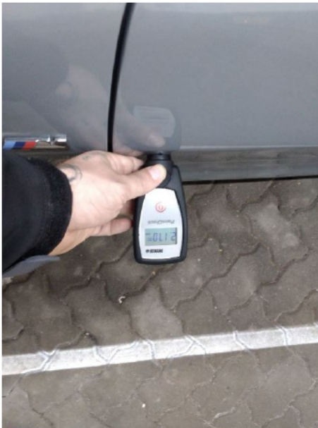
Tür / Vorne Links / Schlecht Repariert
