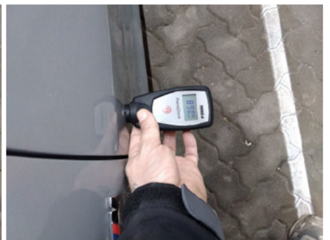
Tür / Vorne Links / Schlecht Repariert
