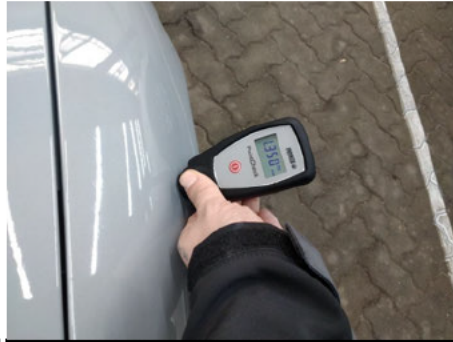
Kotflügel / Vorne Rechts / Schlecht Repariert
