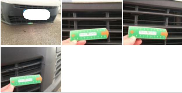
Panneau ARD, Mauvaise réparation, Peindre
