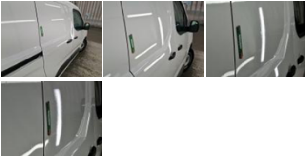
Porte AVD, Mauvaise réparation, Peindre
