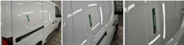
Porte coulissante D, Mauvaise réparation, Peindre
