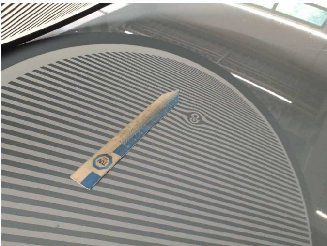
Damage 5: Bonnet: Bonnet (teilweise lackieren) - dent(s) - Paint
