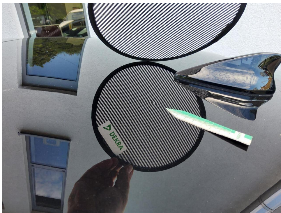
Bild 8 : Dach, eingedellt, drücken
