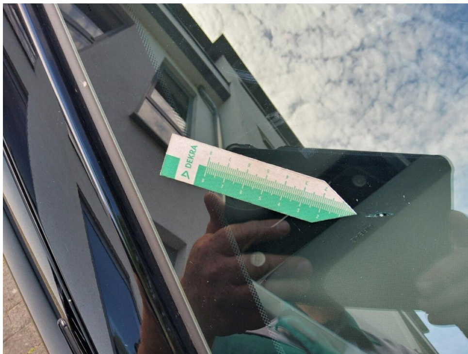
Bild 7 : Frontsscheibe Steinschlag mit Rissbildung
