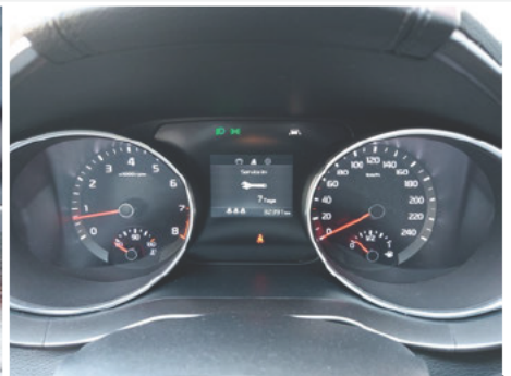
Warnleuchte Inspektion / Fehlt
