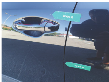
Tür / Vorne Links / Abgewetzt
