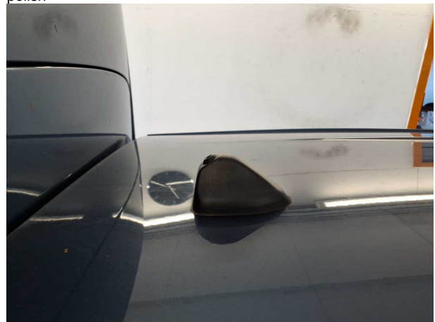
Damage #3: Roof: Stub aerial (Fehlt) - Replace
