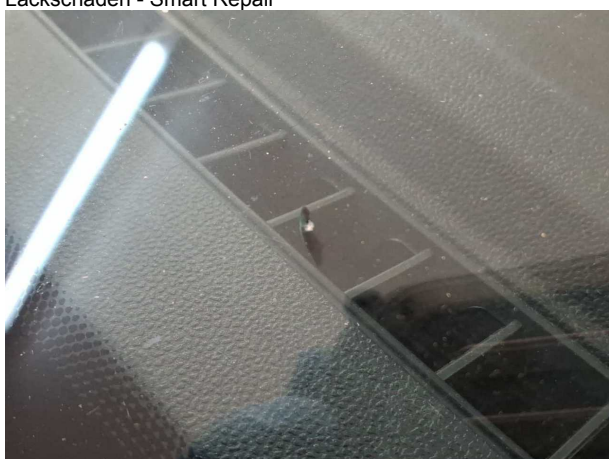
Beschädigung #8: Verglasung: Frontscheibe - Steinschlag - erneuern
