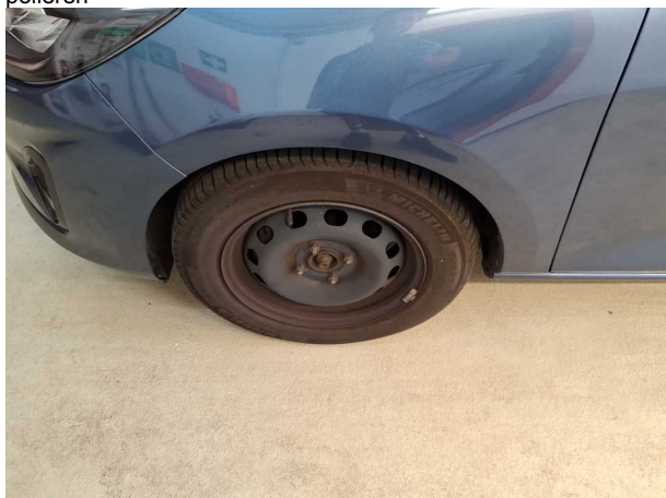
Beschädigung #2: Rad/Reifen: Radblende vorn links (Fehlt) - erneuern
