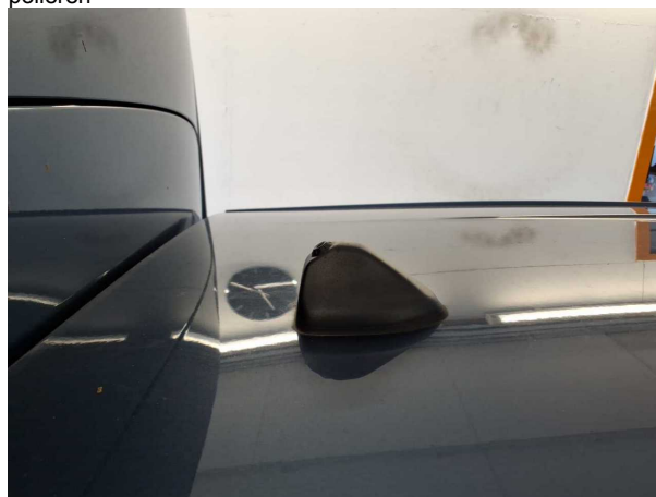
Beschädigung #3: Fahrzeugdach: Antennenstab (Fehlt) - erneuern
