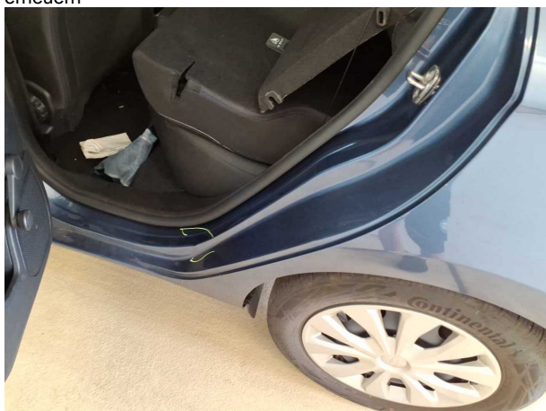
Beschädigung #5: Seitenwand links: Einstieg - Delle(n) - Smart Repair
