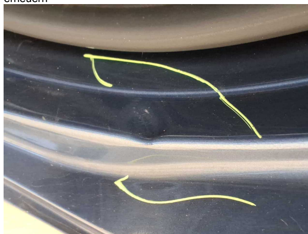
Beschädigung #5: Seitenwand links: Einstieg - Delle(n) - Smart Repair
