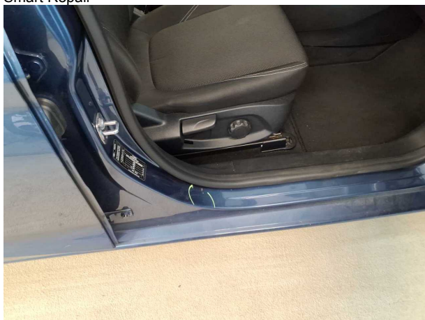
Beschädigung #7: Schweller rechts: Einstieg - Delle / Lackschaden - Smart Repair
