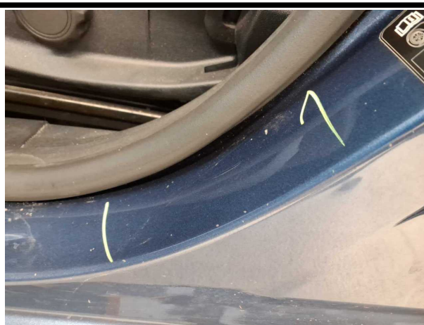
Beschädigung #6: Schweller links: Einstieg - Delle / Lackschaden - Smart Repair
