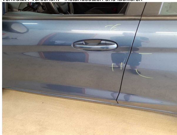
Beschädigung #10: Tür vorn links: Tür - verkratzt / verschürft - instandsetzen und lackieren
