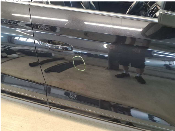
Beschädigung #4: Tür vorn rechts: Tür - Delle(n) - sanft instandsetzen
