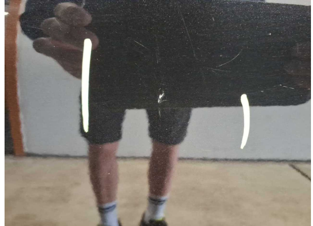
Beschädigung #1: Tür hinten links: Tür - verkratzt / verschürft... auslegen / polieren
