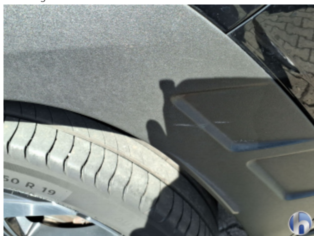
1. Seitenwand - Hinten - Links Kratzer - Smart Repair
