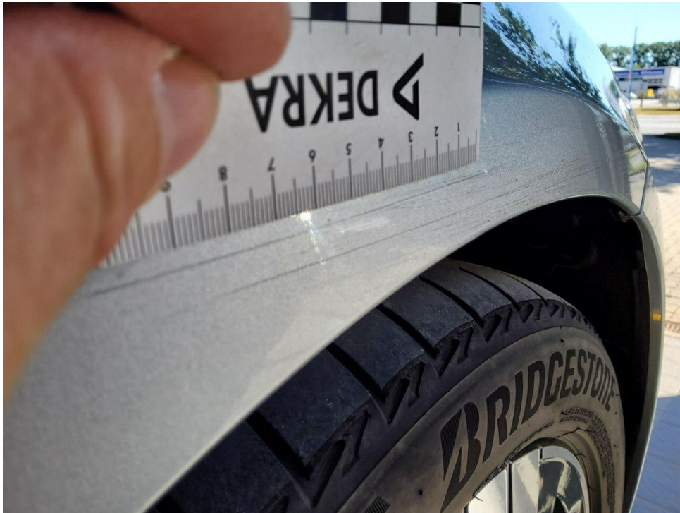
Bild 35 : Kotflügel vorne rechts Lackierung, zerkratzt, lackieren mit Lackaufbau
