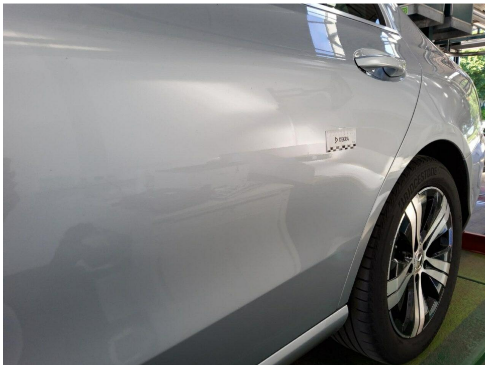
Bild 28 : Tür hinten links Lackierung, zerkratzt, lackieren mit Lackaufbau
