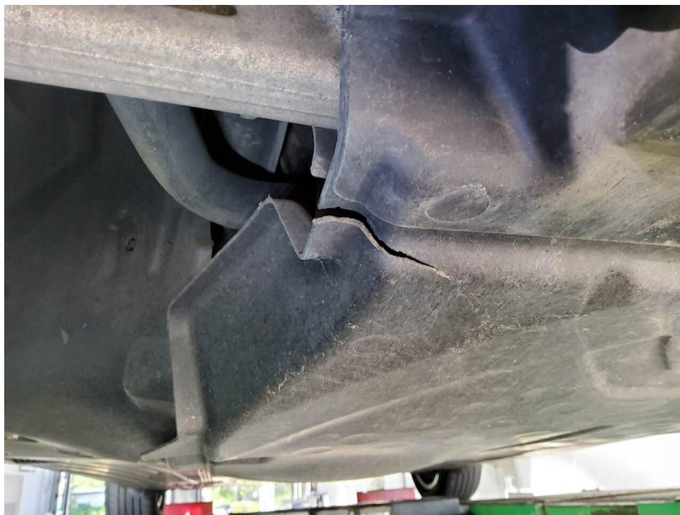
Bild 14 : Hinterer Unterfahrschutz gebrochen
