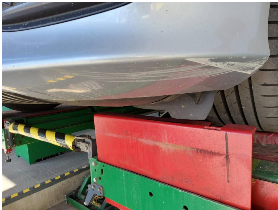
Bild 27 : Stoßfänger vorne, verformt, instandsetzen und lackieren mit Lackaufbau
