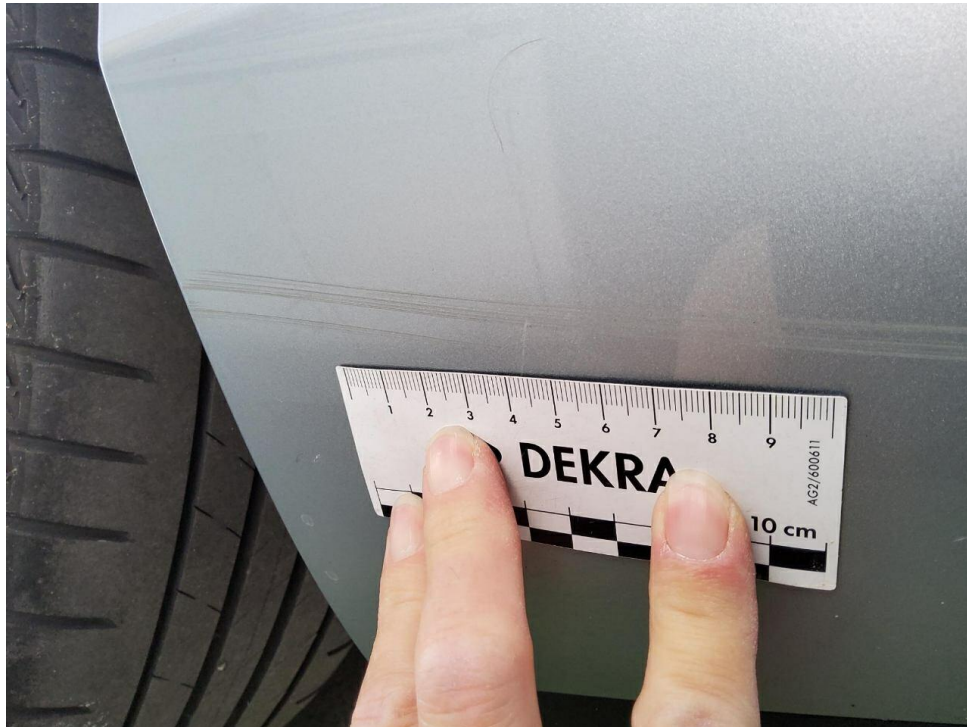
Bild 31 : Stoßfänger hinten Lackierung, zerkratzt, lackieren
