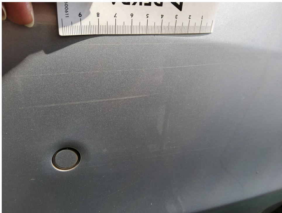
Bild 33 : Stoßfänger hinten Lackierung, zerkratzt, lackieren
