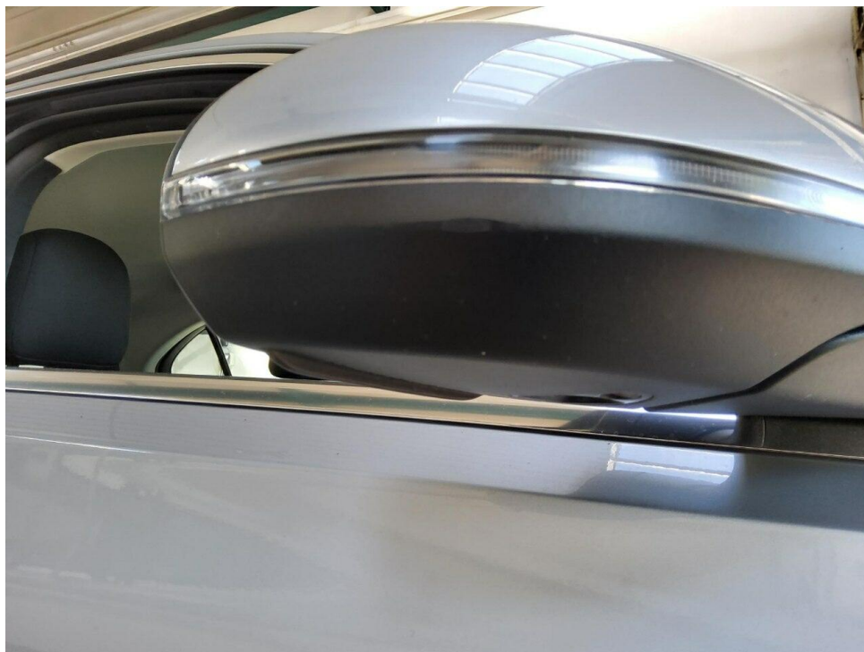
Bild 41 : Außenspiegel rechts Gehäuse, verschrammt, Gebrauchsspur
