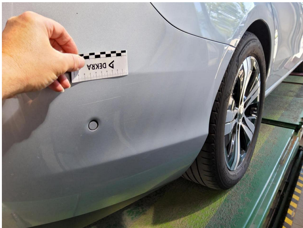
Bild 32 : Stoßfänger hinten Lackierung, zerkratzt, lackieren
