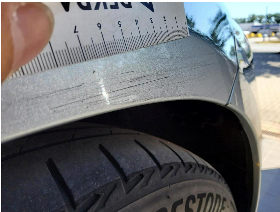
Bild 36 : Kotflügel vorne rechts Lackierung, zerkratzt, lackieren mit Lackaufbau
