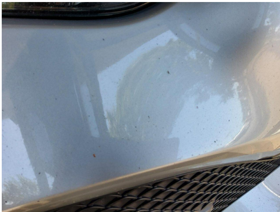
Bild 26 : Stoßfänger vorne, verformt, instandsetzen und lackieren mit Lackaufbau
