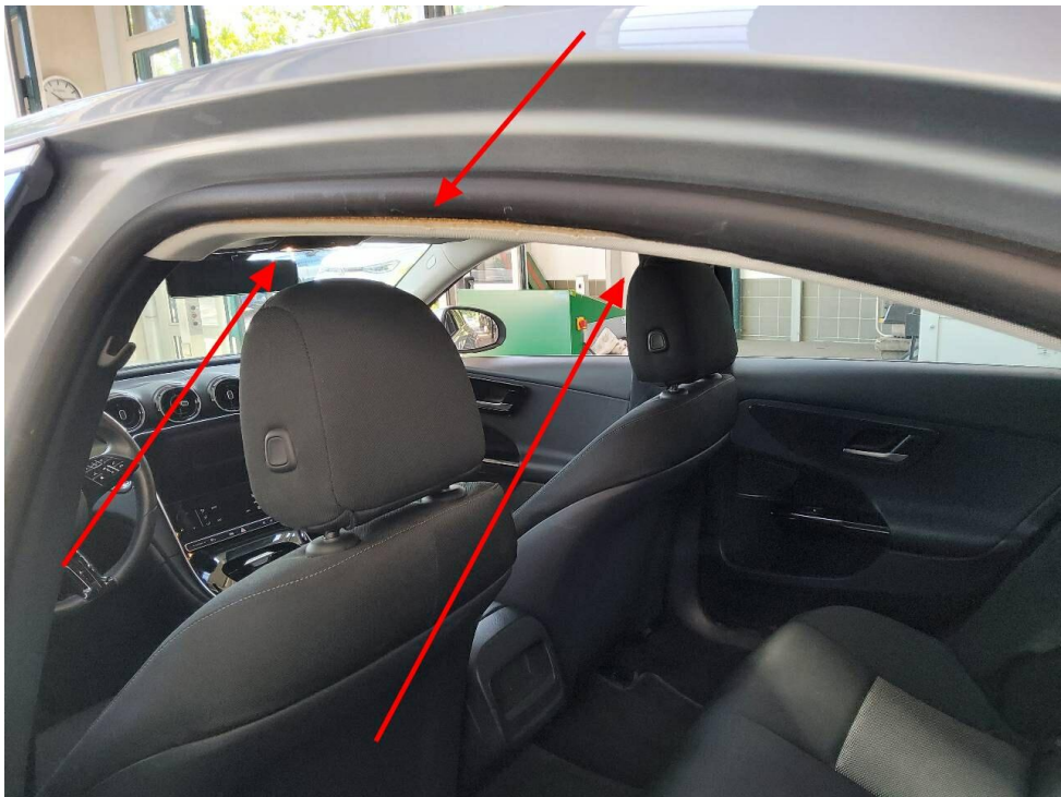
Bild 19 : Dachhimmel hinten links befestigen
