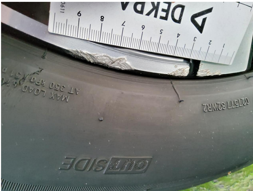
Bild 18 : Felge hinten links zerkratzt - Glanzgedreht
