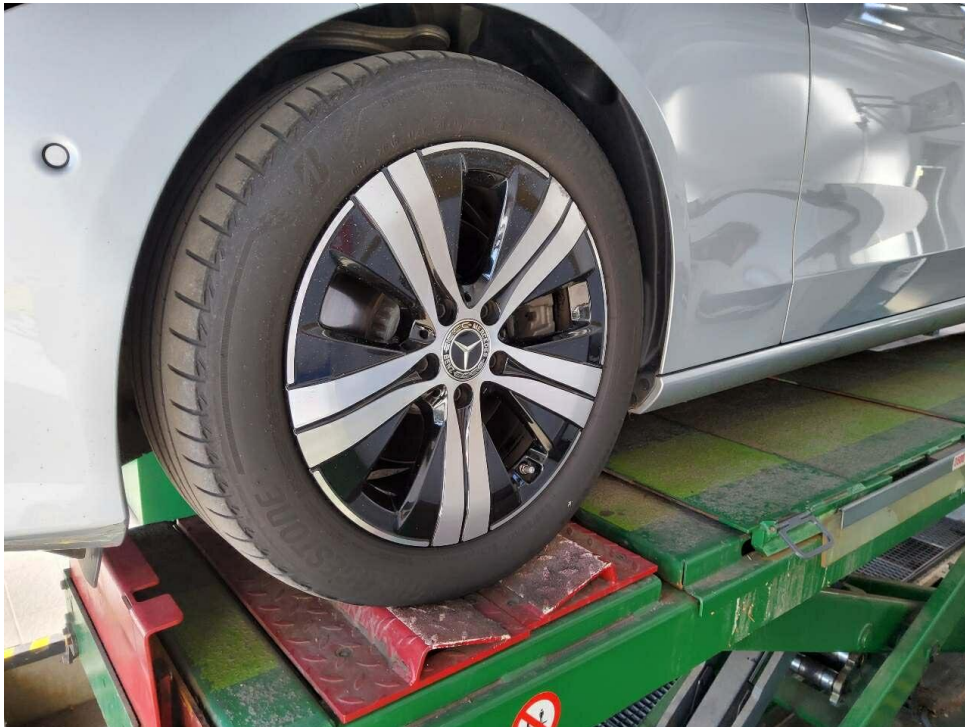
Bild 15 : Felge vorn links zerkratzt - Glanzgedreht
