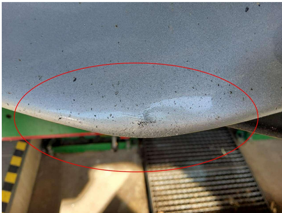
Bild 23 : Stoßfänger vorne, verformt, instandsetzen und lackieren mit Lackaufbau
