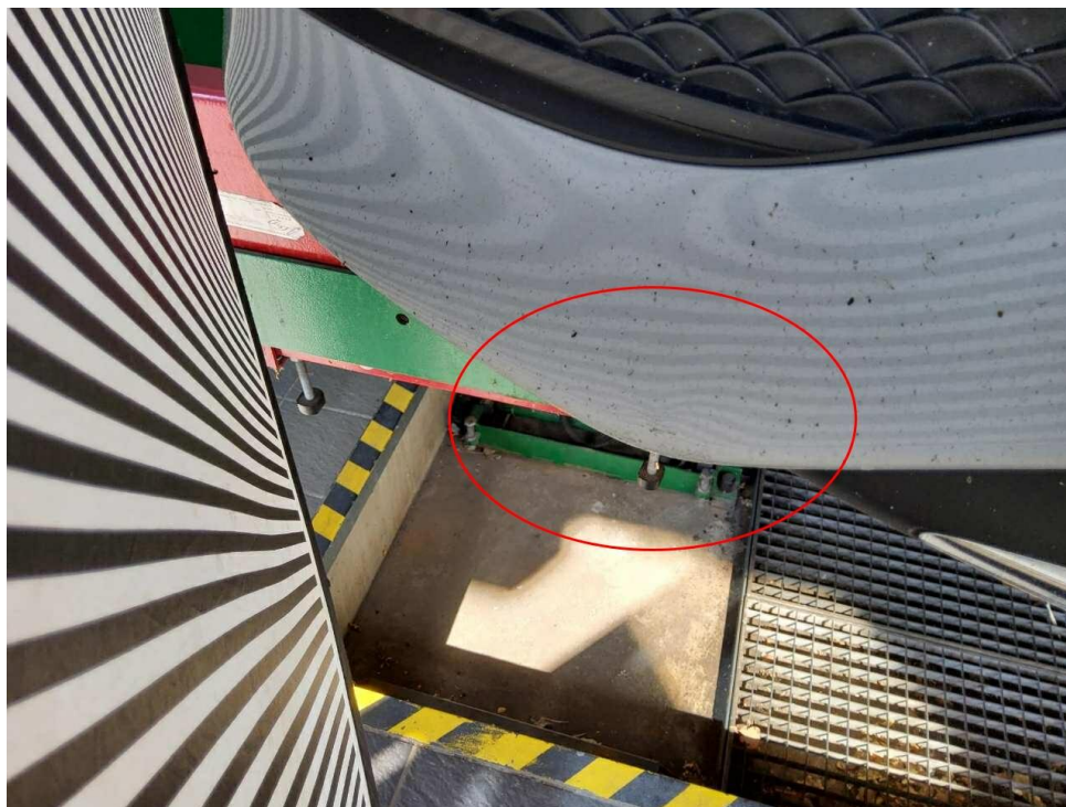
Bild 24 : Stoßfänger vorne, verformt, instandsetzen und lackieren mit Lackaufbau
