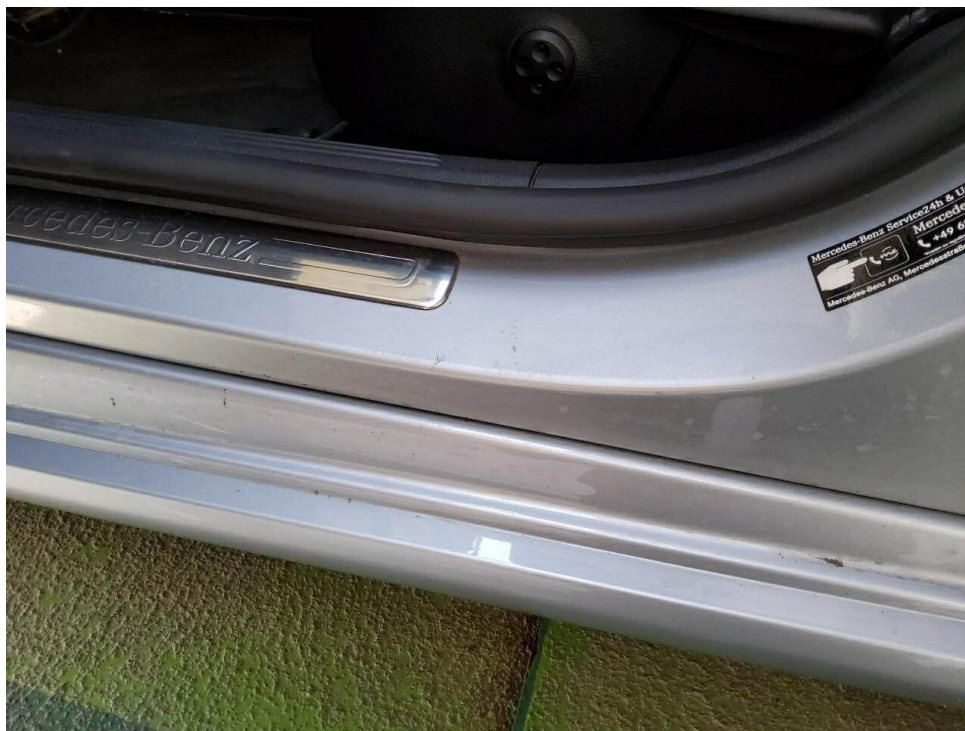
Bild 42 : Tür vorne links Einstieg Lackierung, verschrammt, Gebrauchsspur
