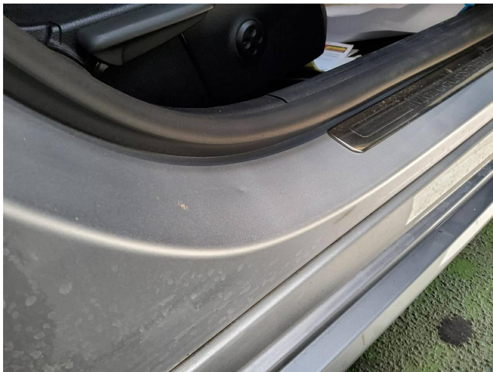
Bild 43 : Tür vorne rechts Einstieg, eingedellt, Gebrauchsspur
