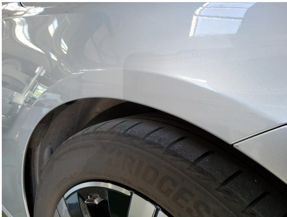
Bild 34 : Kotflügel vorne rechts Lackierung, zerkratzt, lackieren mit Lackaufbau
