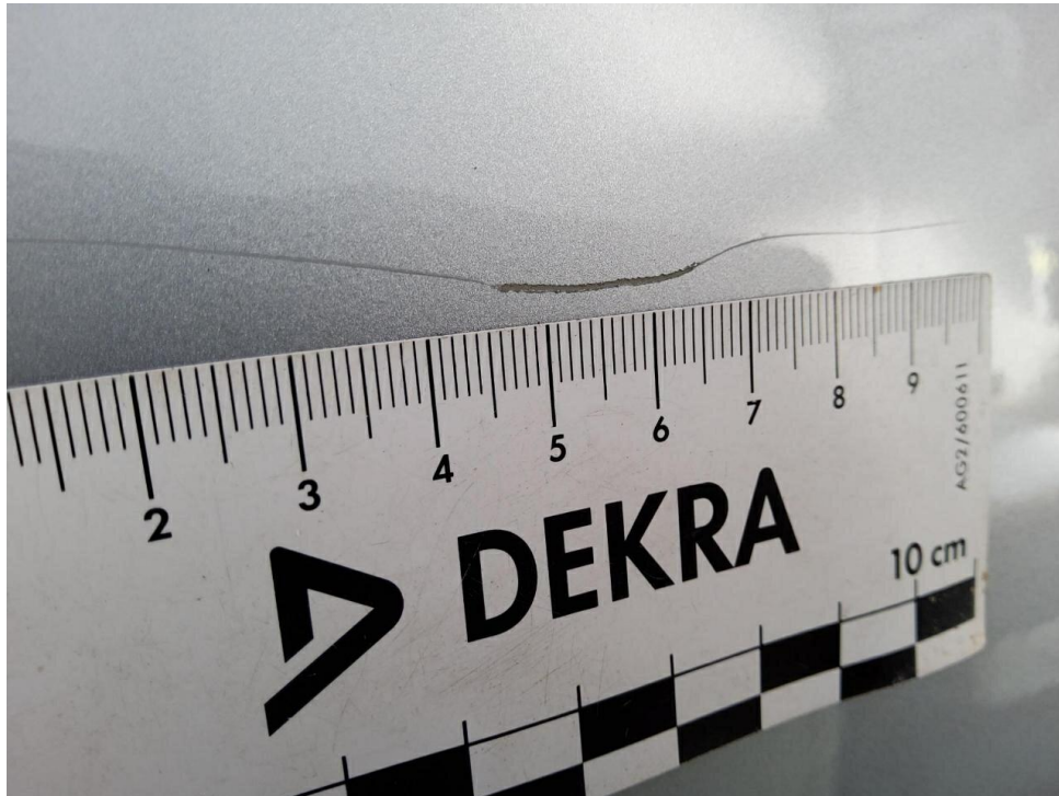
Bild 29 : Tür hinten links Lackierung, zerkratzt, lackieren mit Lackaufbau
