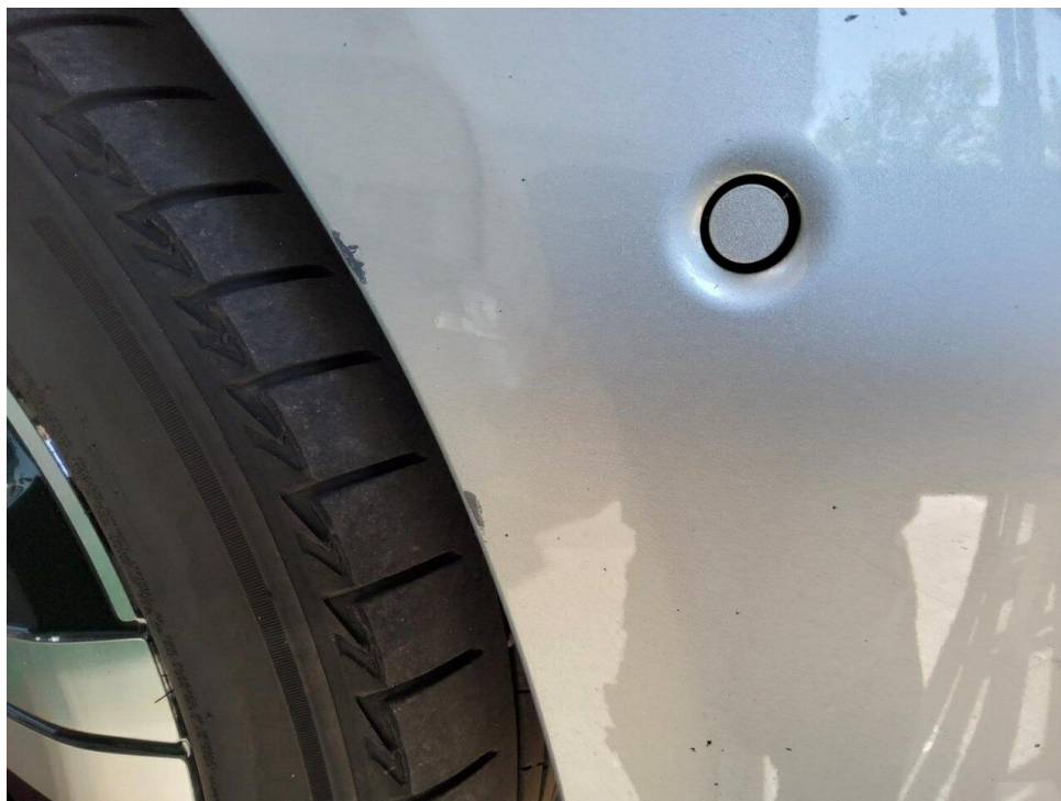
Bild 25 : Stoßfänger vorne, verformt, instandsetzen und lackieren mit Lackaufbau
