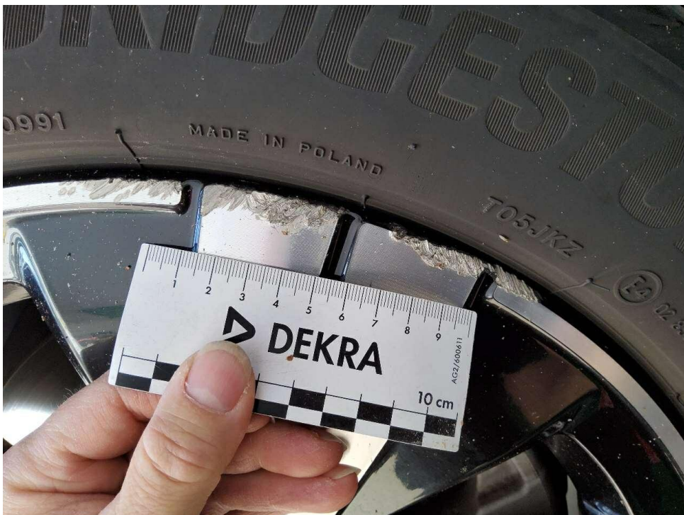
Bild 16 : Felge vorn links zerkratzt - Glanzgedreht
