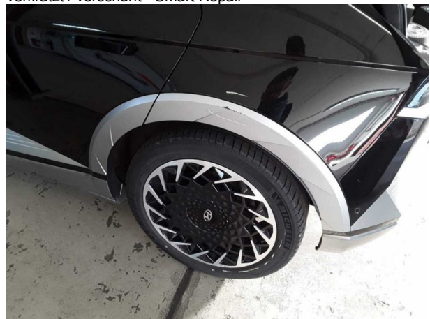
Beschädigung #6: Seitenwand links: Radhausverbreiterung - verkratzt / verschürft - Smart Repair
