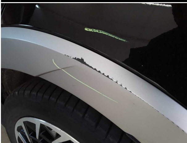
Beschädigung #6: Seitenwand links: Radhausverbreiterung - verkratzt / verschürft - Smart Repair
