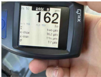
Lackstärke Kotflügel vorne links
