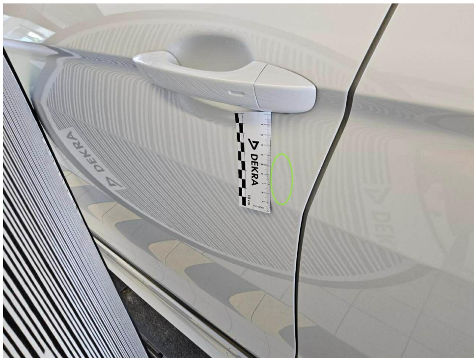
Bild 13 : Tür vorne links, mehrfach eingedellt, Gebrauchsspur
