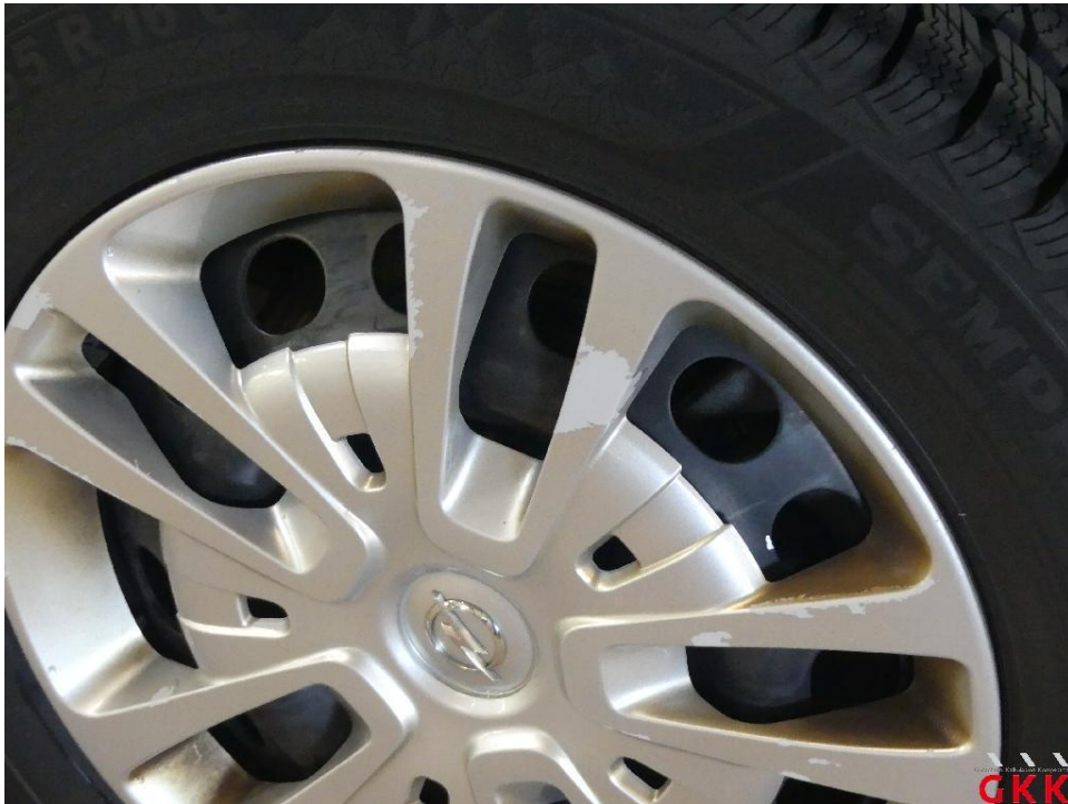
Bild 27 Radkappe(n), hinten links, beschädigt, ersetzen
