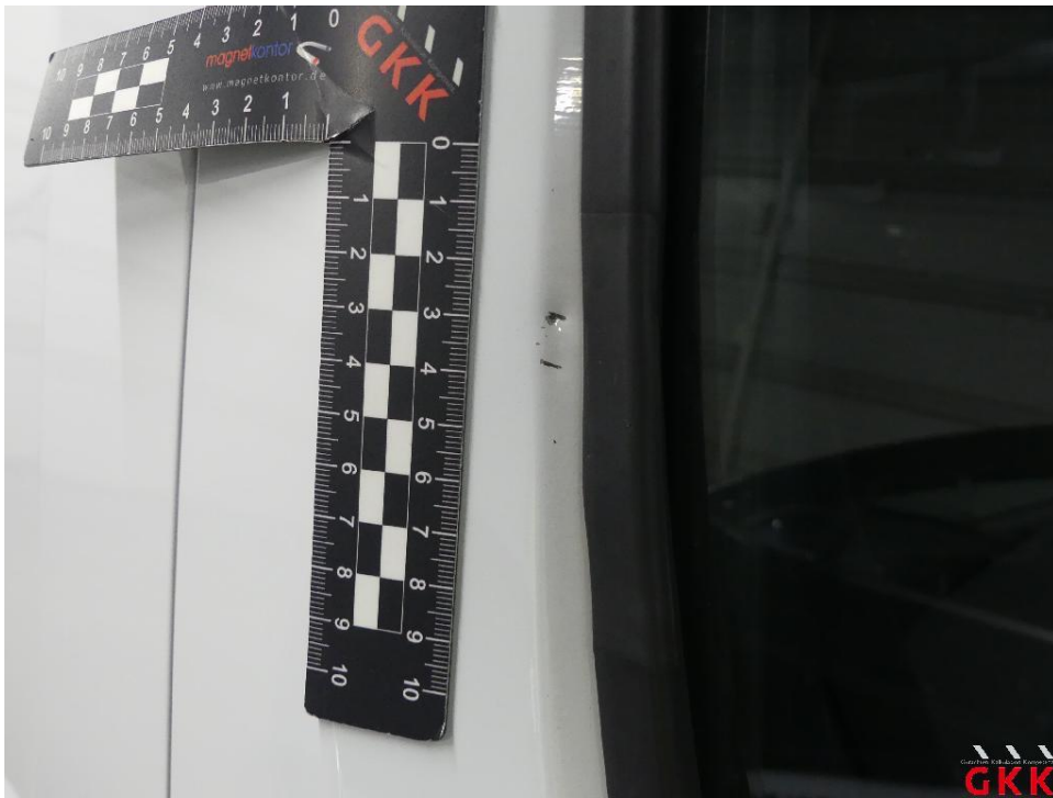
Bild 18 Tür vorne rechts, beschädigt, instand setzen - lackieren
