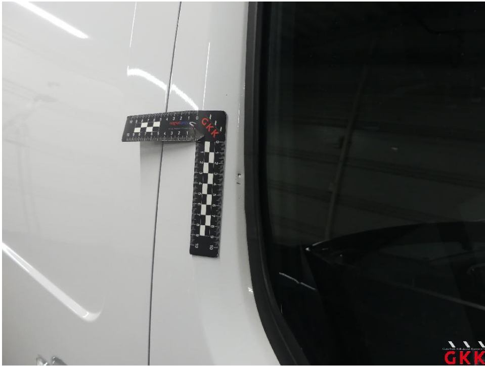
Bild 17 Tür vorne rechts, beschädigt, instand setzen - lackieren
