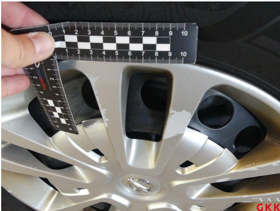
Bild 28 Radkappe(n), hinten links, beschädigt, ersetzen
