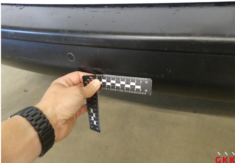
Bild 24 Stoßfänger hinten, Verkleidung -unlackiert-, verkratzt, ersetzen
