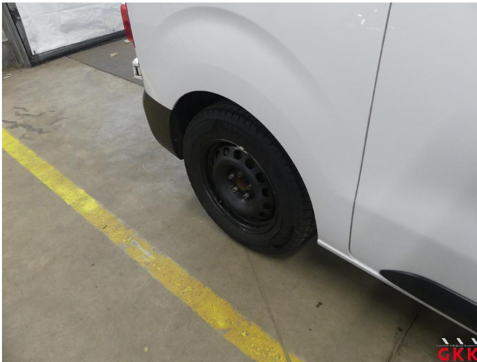
Bild 20 Radkappe(n), hinten rechts, fehlt, ersetzen
