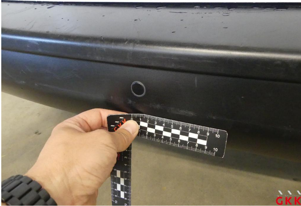
Bild 25 Stoßfänger hinten, Verkleidung -unlackiert-, verkratzt, ersetzen
