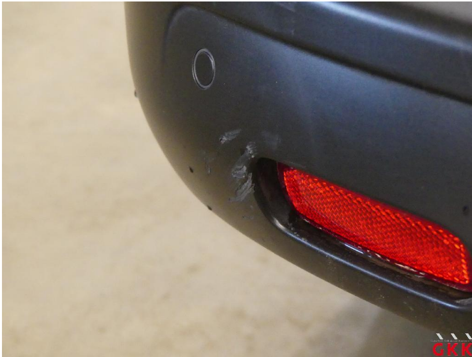
Bild 26 Stoßfänger hinten, Verkleidung -unlackiert-, verkratzt, ersetzen
