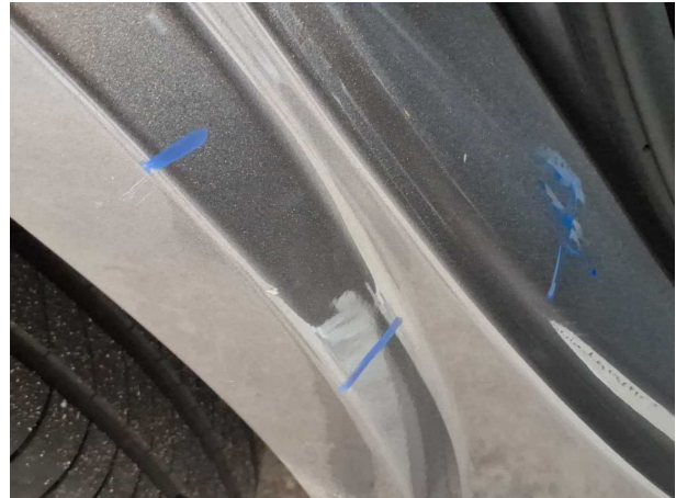
Beschädigung #1: Seitenwand rechts: Einstieg - verkratzt / verschürft - Smart Repair
