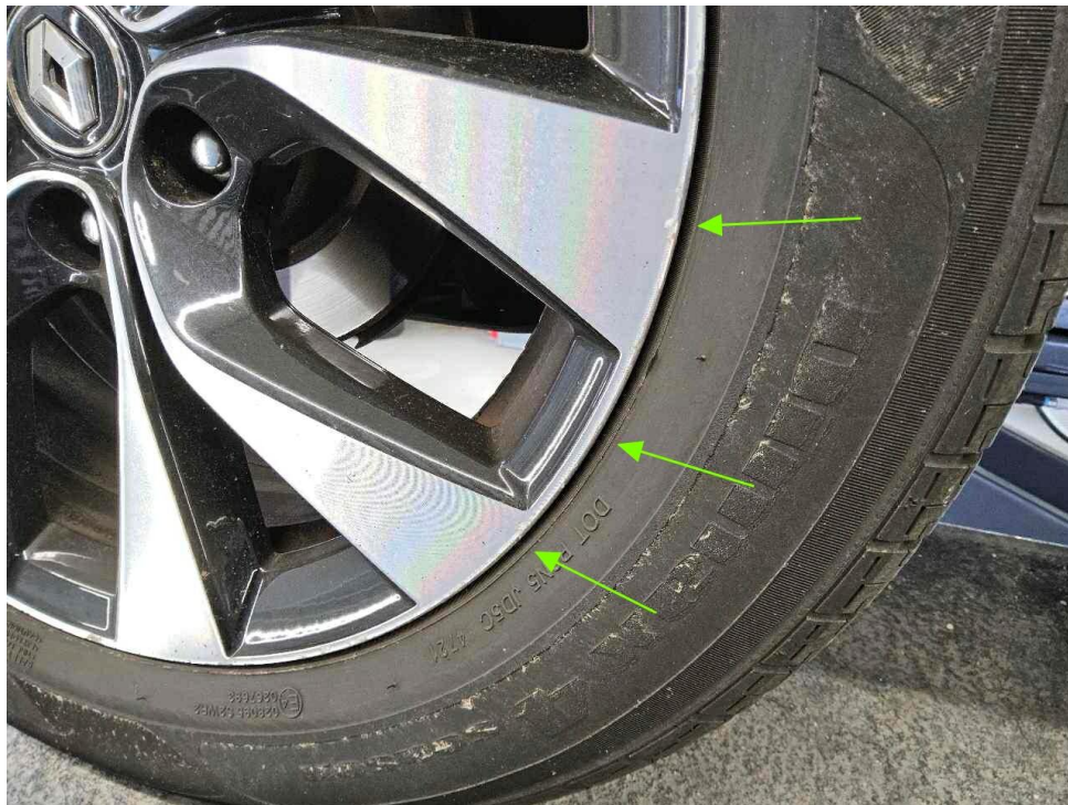
Bild 13 : Felge vorne links und hinten rechts, glanzgedreht verschrammt / oxidiert
