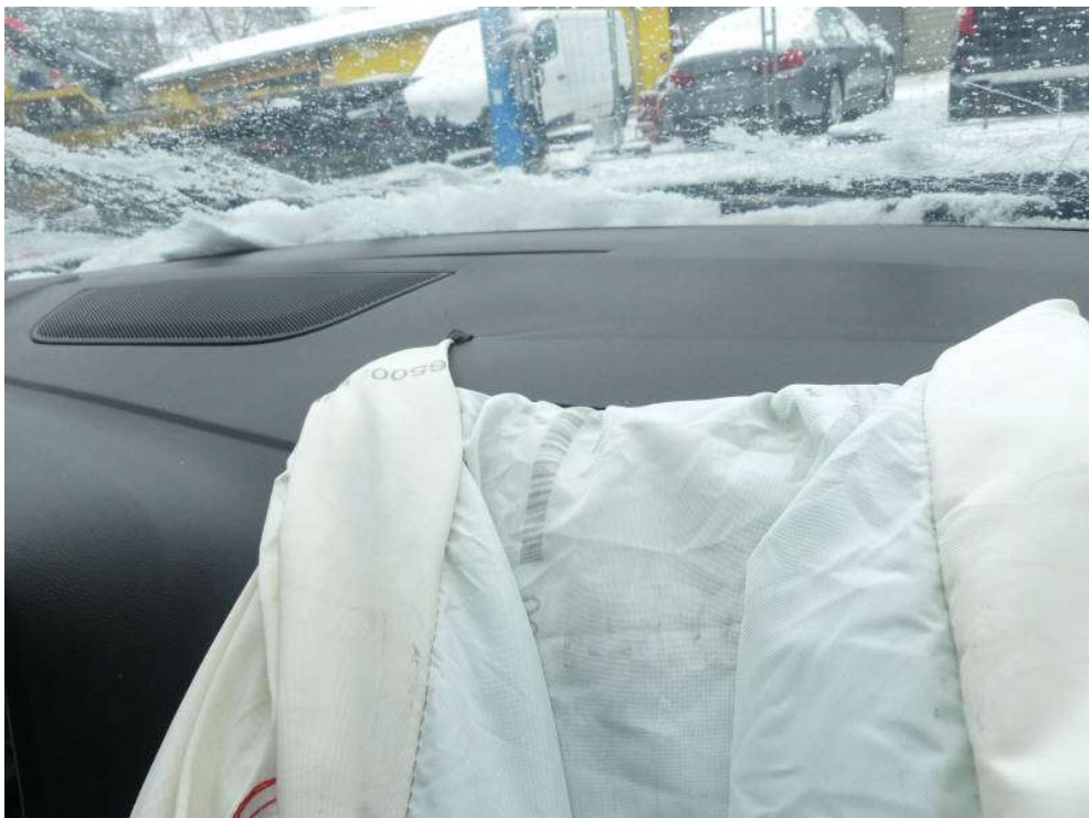
Bild 32: Armaturenbrett gerissen durch Airbag
