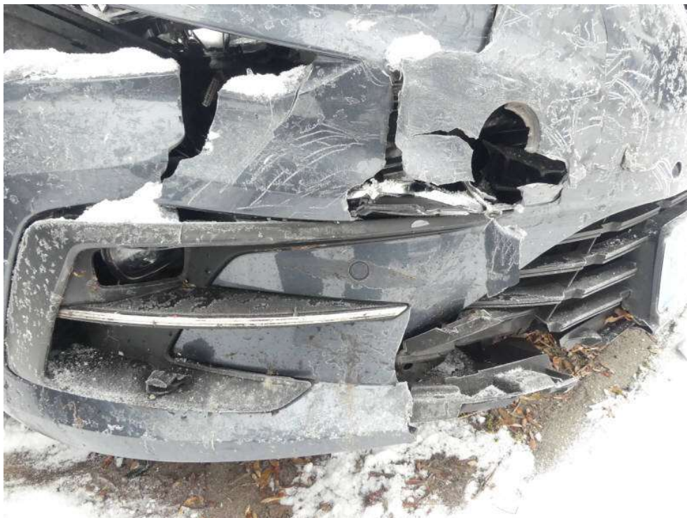
Bild 6: Stoßfänger vorne gebrochen
