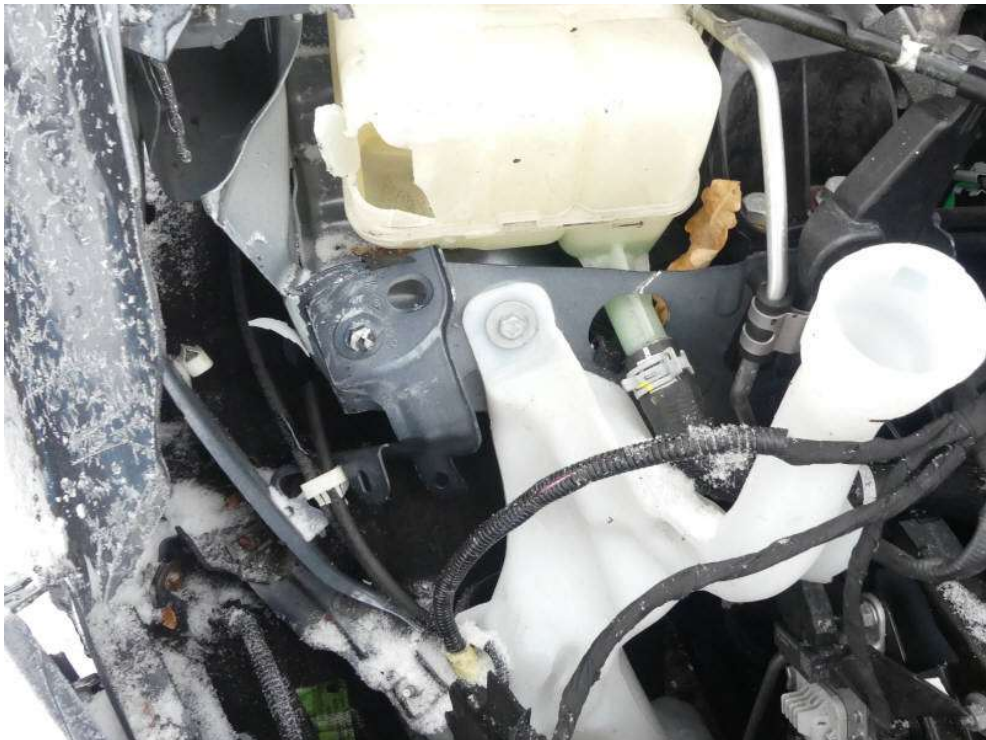
Bild 22: Kotflügelaufnahme und Frontblech deformiert
