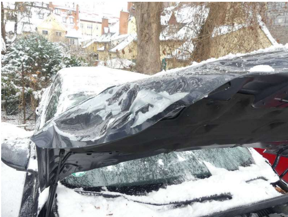
Bild 16: Motorhaube stark deformiert und verschoben
