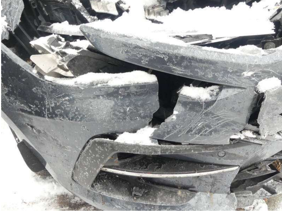
Bild 7: Stoßfänger vorne gebrochen
