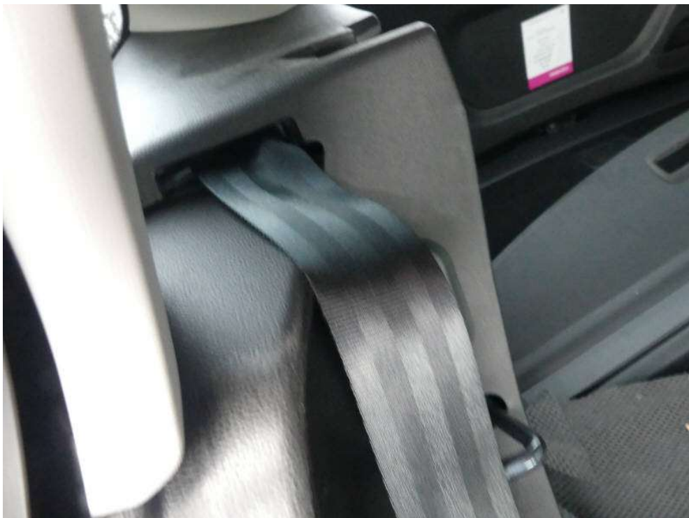
Bild 34: Gurtstraffer hinten rechts ausgelöst
