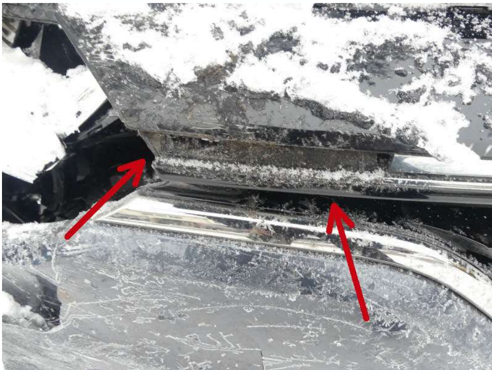
Bild 12: oberes Kühlergrillgitter gebrochen und zerkratzt
