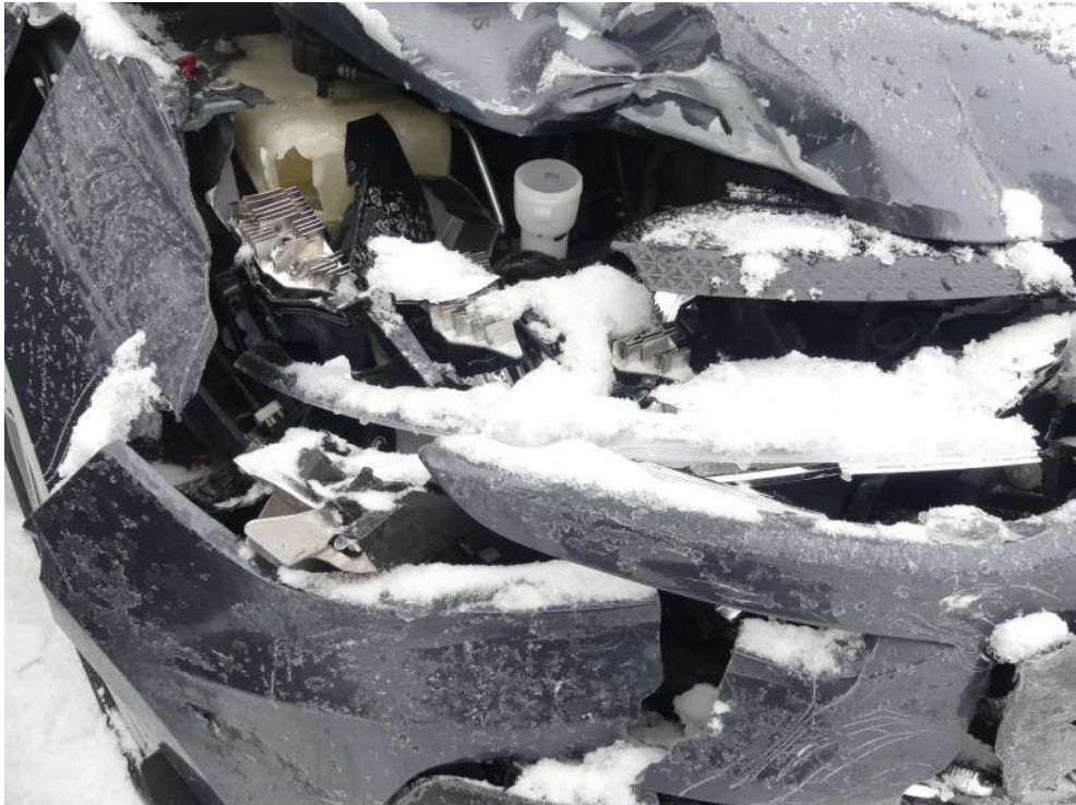
Bild 15: Scheinwerfer rechts komplett zerstört
