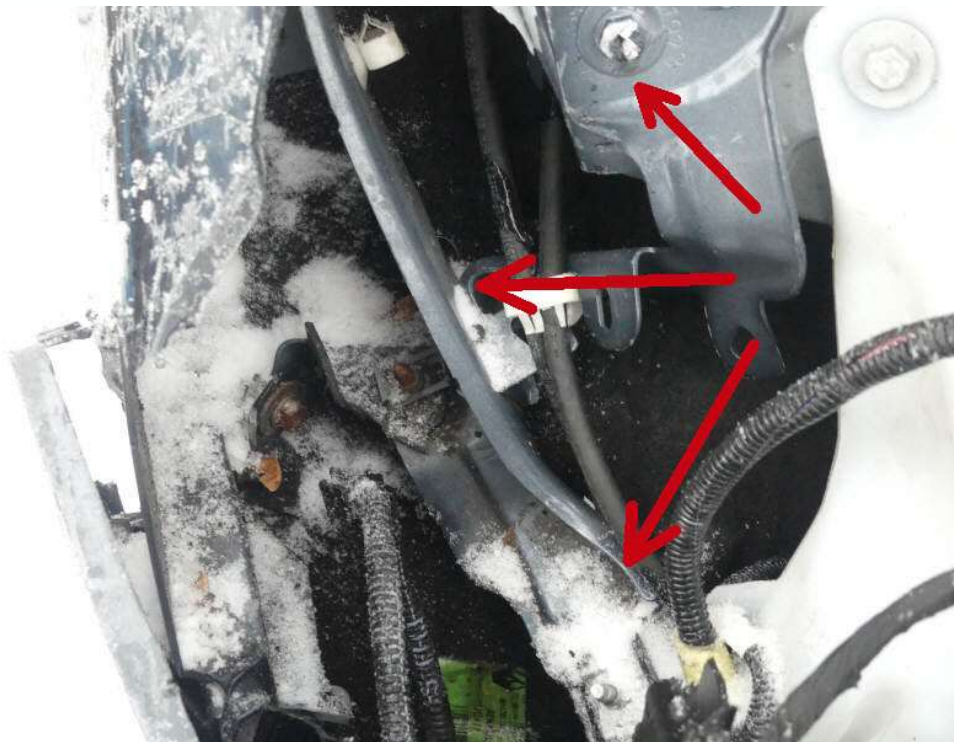
Bild 20: Kotflügelaufnahme und Frontblech deformiert
