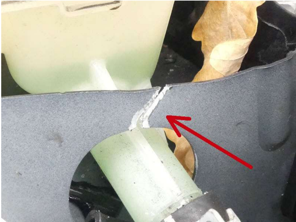
Bild 23: Frontblech deformiert und gerissen
