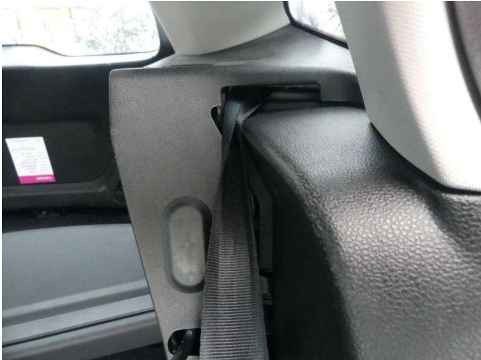
Bild 37: Gurtstraffer hinten links ausgelöst
