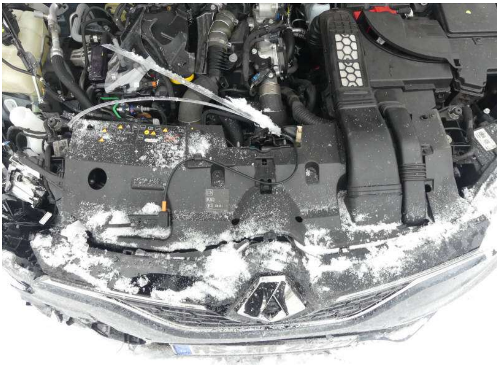
Bild 27: Abdeckung Schlossträger gerbochen
