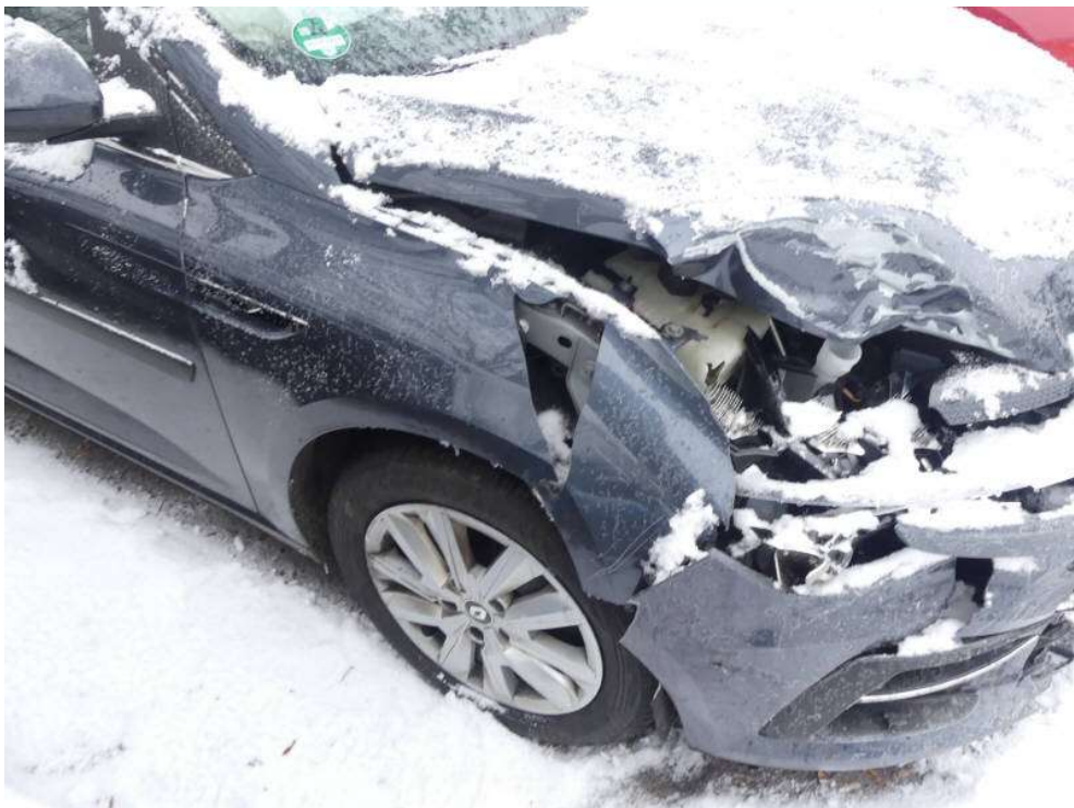
Bild 14: Kotflügel rechts gebrochen
