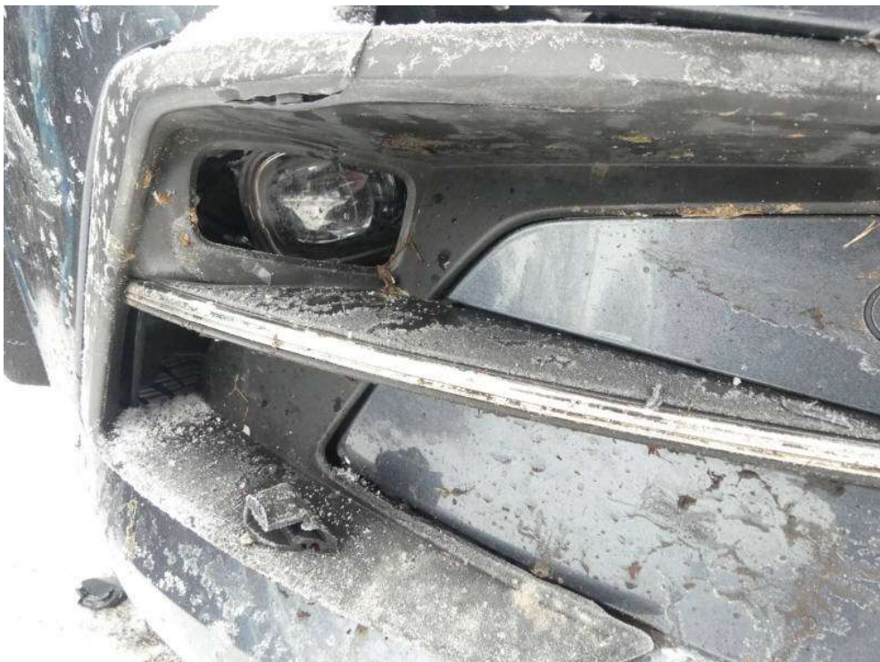
Bild 38: Nebelscheinwerfer rechts gebrochen
