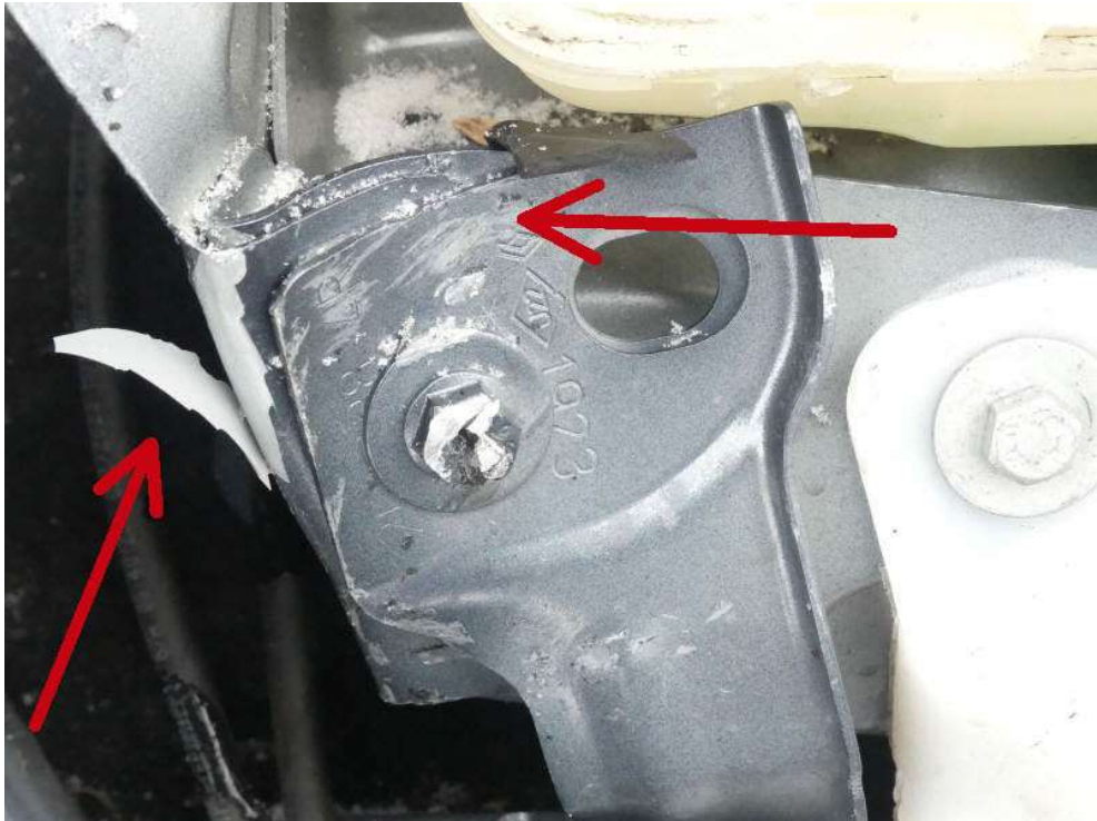
Bild 21: Kotflügelaufnahme und Frontblech deformiert
