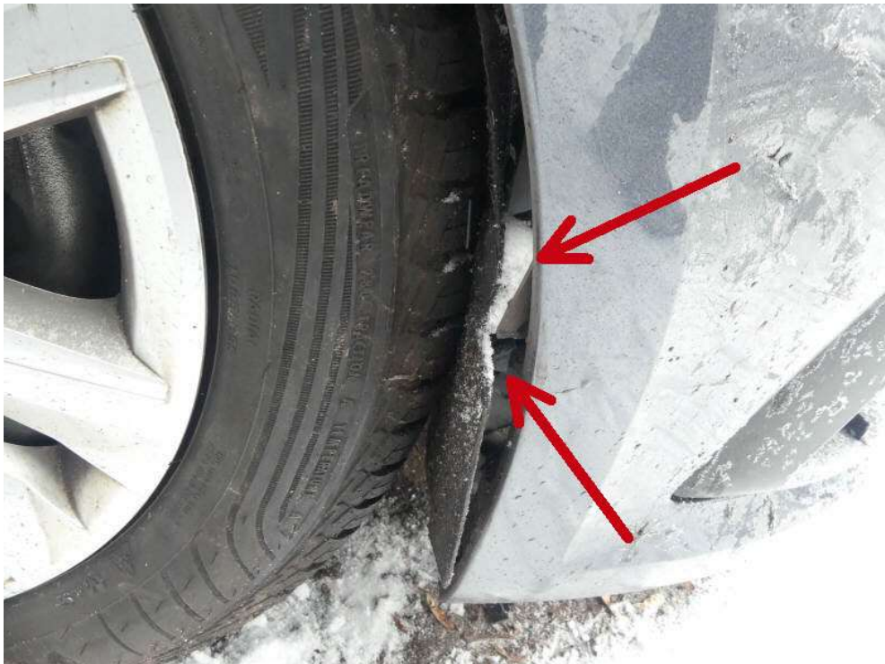
Bild 8: Radhausschale vorne rechts gebrochen
