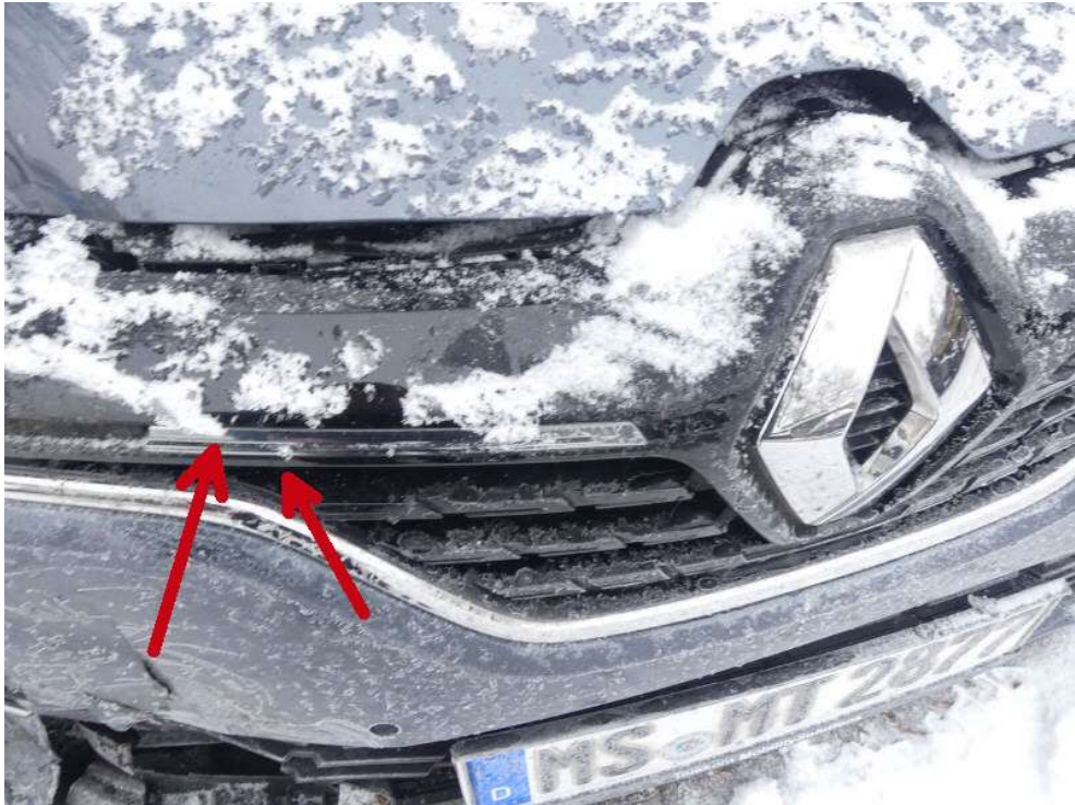
Bild 13: oberes Kühlergrillgitter gebrochen und zerkratzt
