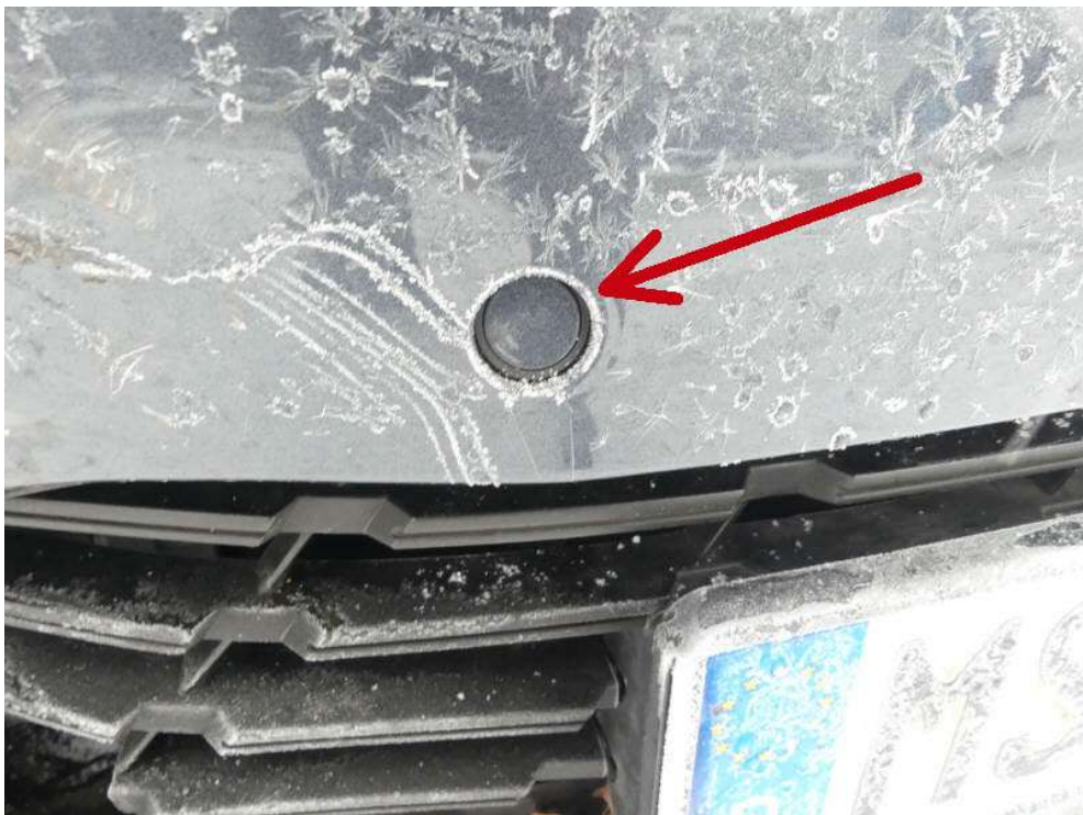
Bild 10: Einparksensoren vorne rechts beaufschlagt
