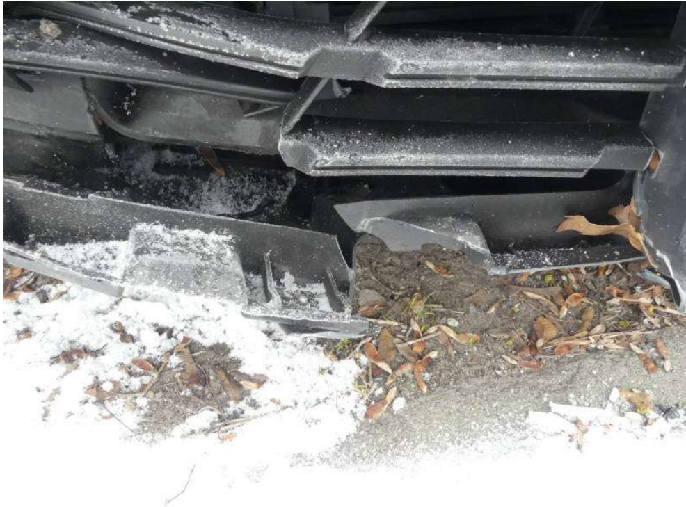
Bild 11: unteres Kühlergrillgitter gebrochen
