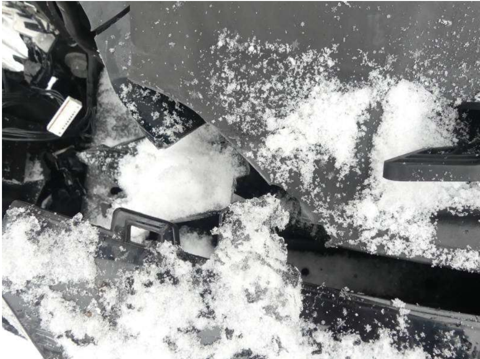
Bild 27: Abdeckung Schlossträger gerbochen
