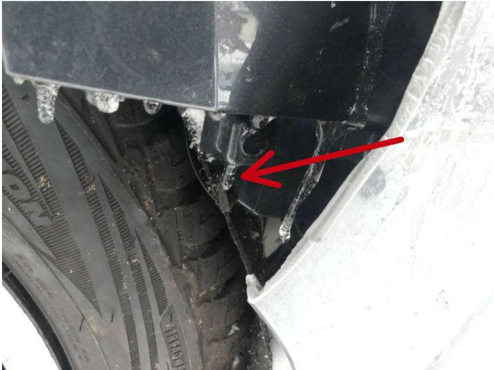
Bild 9: Radhausschale vorne rechts gebrochen
