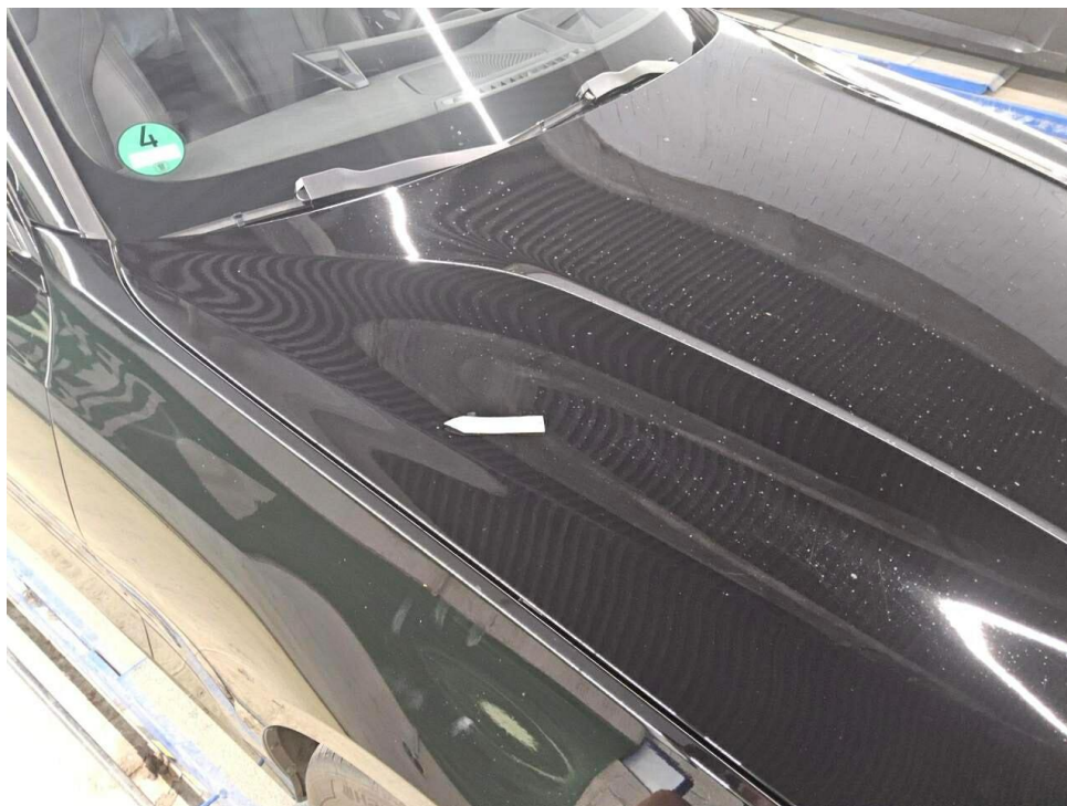
Bild 5 : Motorhaube Lackierung, Steinschlag, Gebrauchsspur
