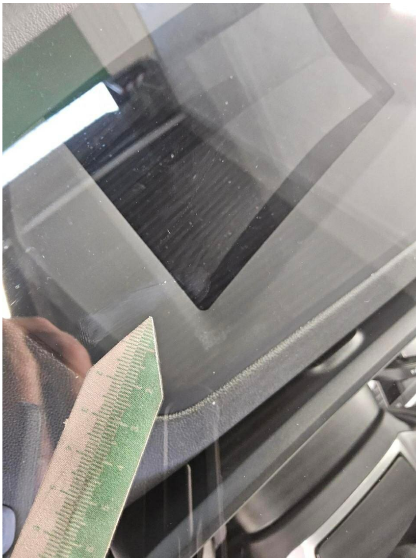
Bild 8 : Frontscheibe, Steinschlag, Gebrauchsspur
