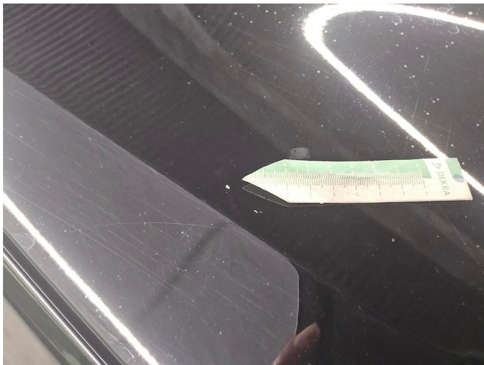
Bild 6 : Motorhaube Lackierung, Steinschlag, Gebrauchsspur
