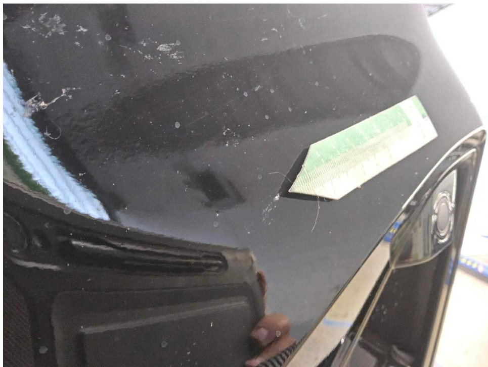
Bild 2 : Stoßfänger vorne Lackierung, Steinschlag, Gebrauchsspur
