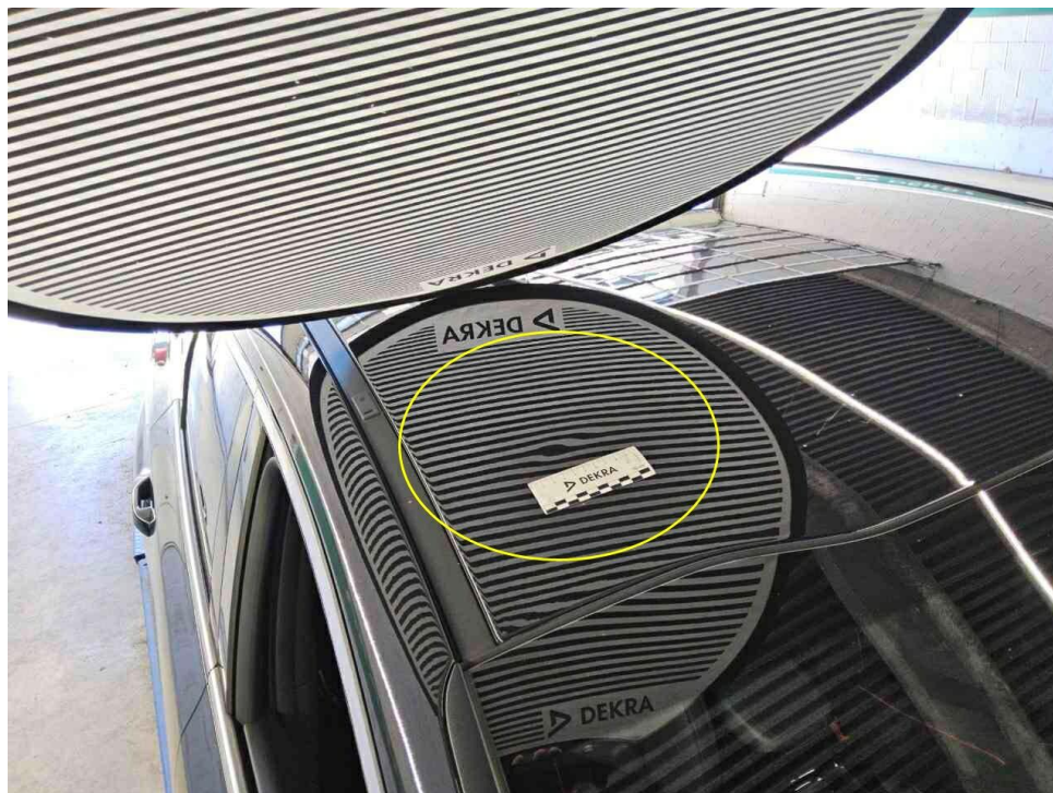
Bild 14 : Dach, eingedellt, drücken
