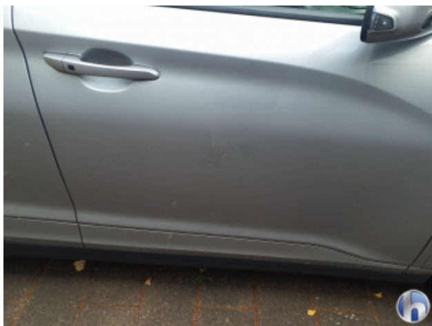
2. Tür Vorne - Rechts Steinschlag - Smart Repair
