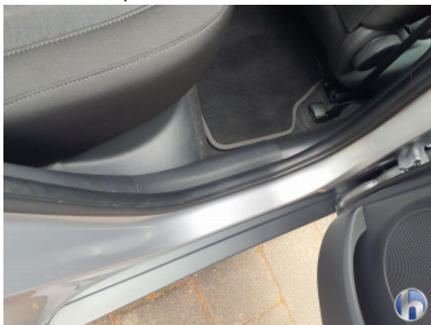
4. Verkleidung Gebrauchsspuren - Ohne Reparatur
