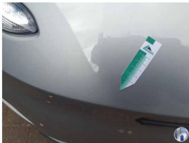
5. Kühlergrill Außen vorne Steinschlag - Smart Repair
