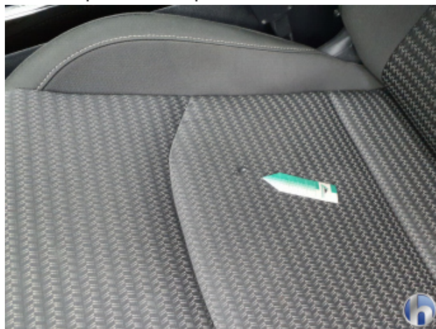
7. Sitz Innenraum links vorne Riss - Erneuern
