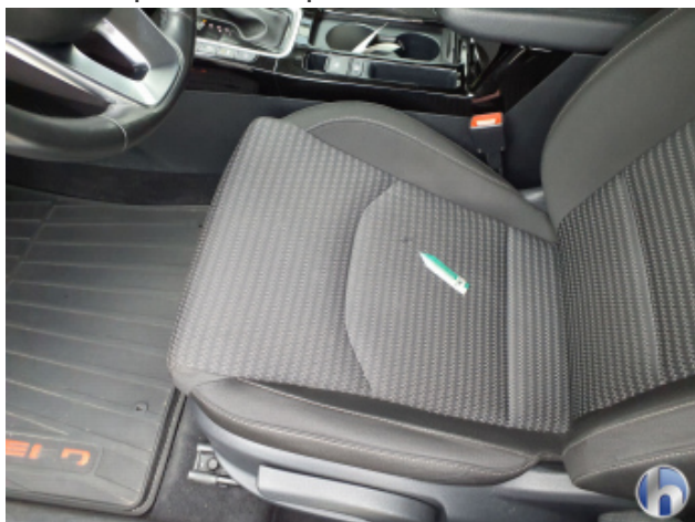
7. Sitz Innenraum links vorne Riss - Erneuern
