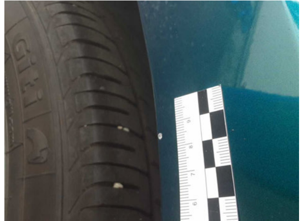
Beschädigung #1: Seitenwand rechts: Seitenwand - Steinschlag - Smart Repair
