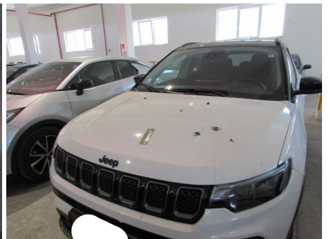
Cofano anteriore / - / Ammaccato vernice incisa
