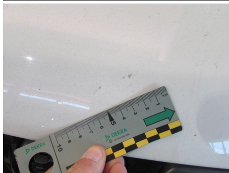
Cofano anteriore / - / Ammaccato vernice incisa
