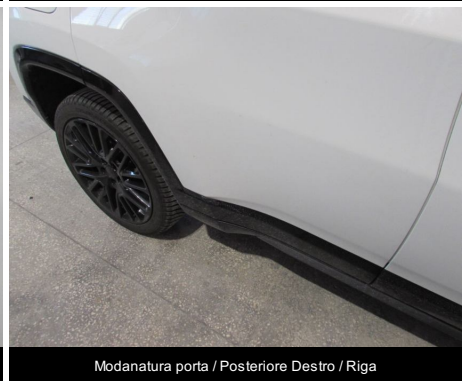
Porta / Posteriore Destro / Ammaccato vernice incisa
