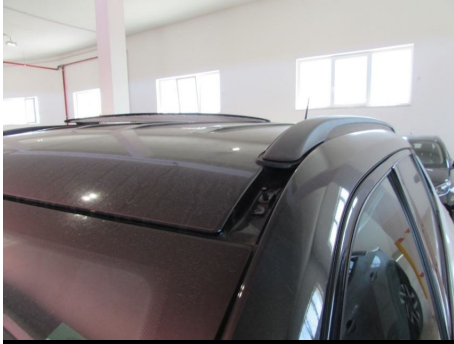
Modanatura barra tetto / Anteriore Sinistro / Mancante
