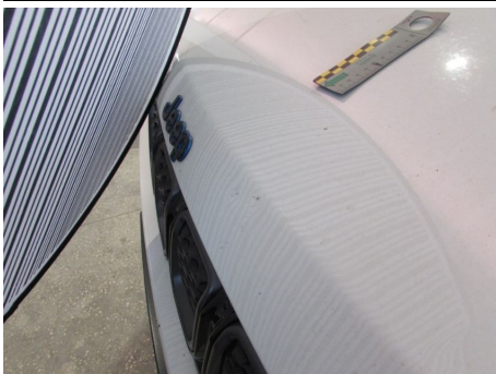
Cofano anteriore / - / Ammaccato vernice incisa
