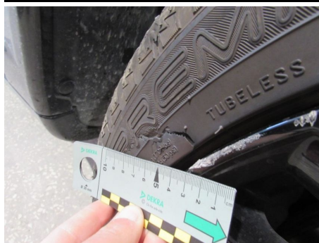
Pneumatico / Anteriore Destro / Tagliato/Strappato
