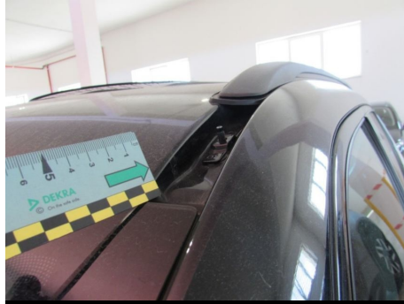
Modanatura barra tetto / Anteriore Sinistro / Mancante
