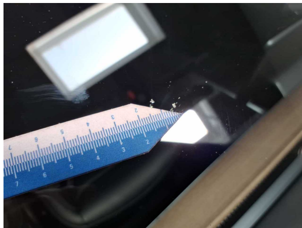
Beschädigung #1: Verglasung: Frontscheibe - Steinschlag - erneuern
