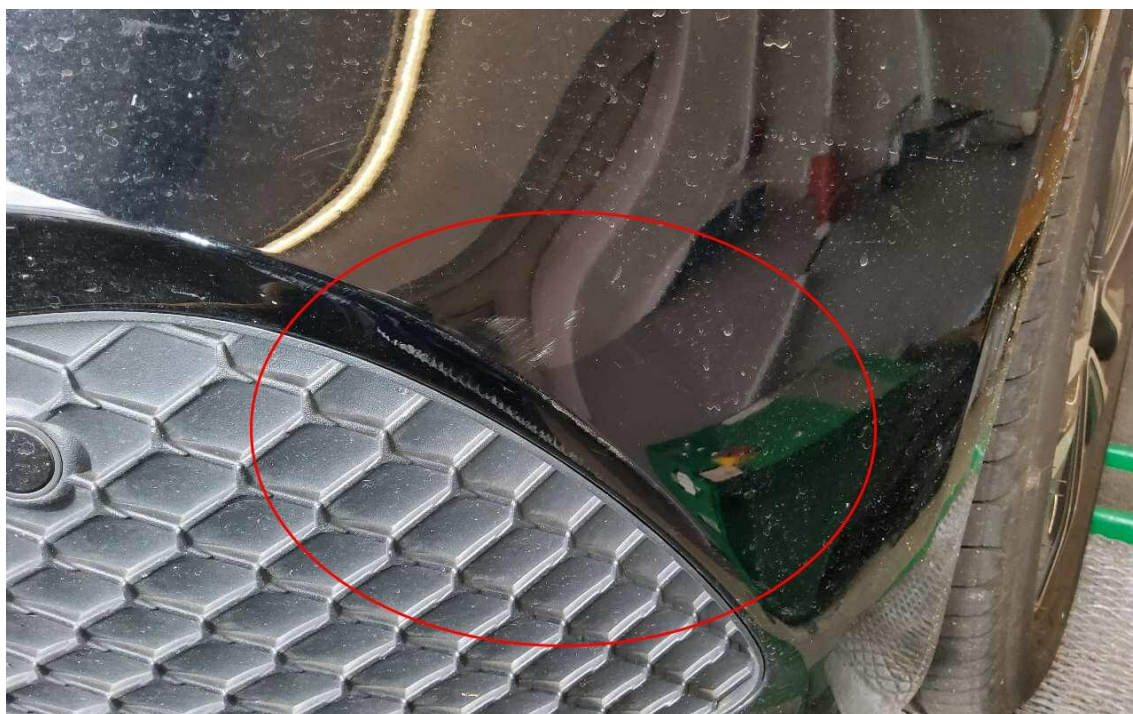
Bild 16 : Stoßfänger vorne verkratzt
