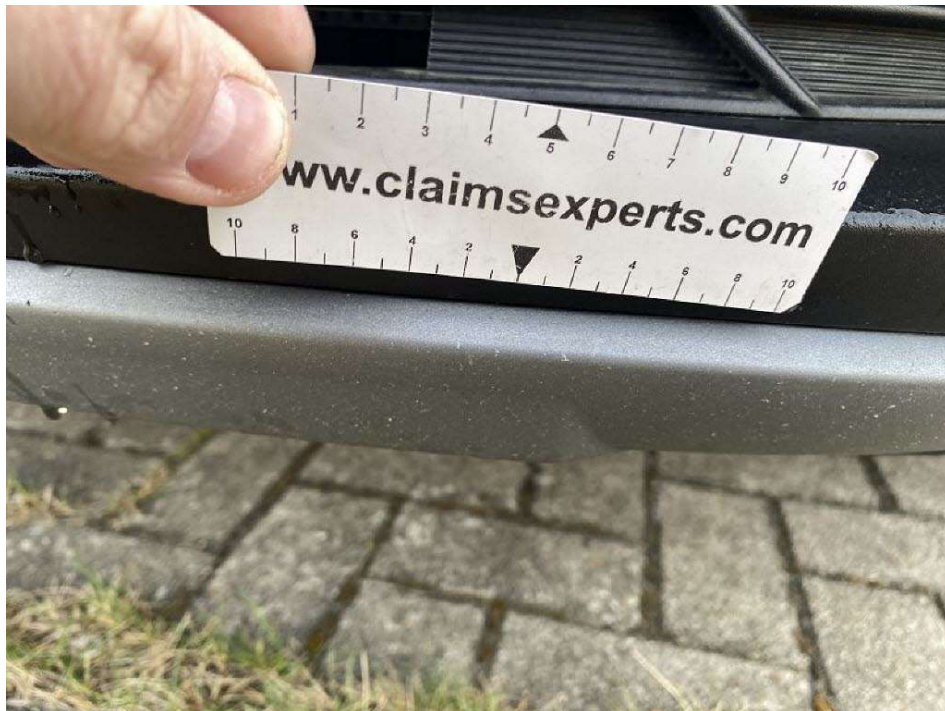
Bild 19 Spoiler vorne kratzbeschädigt
