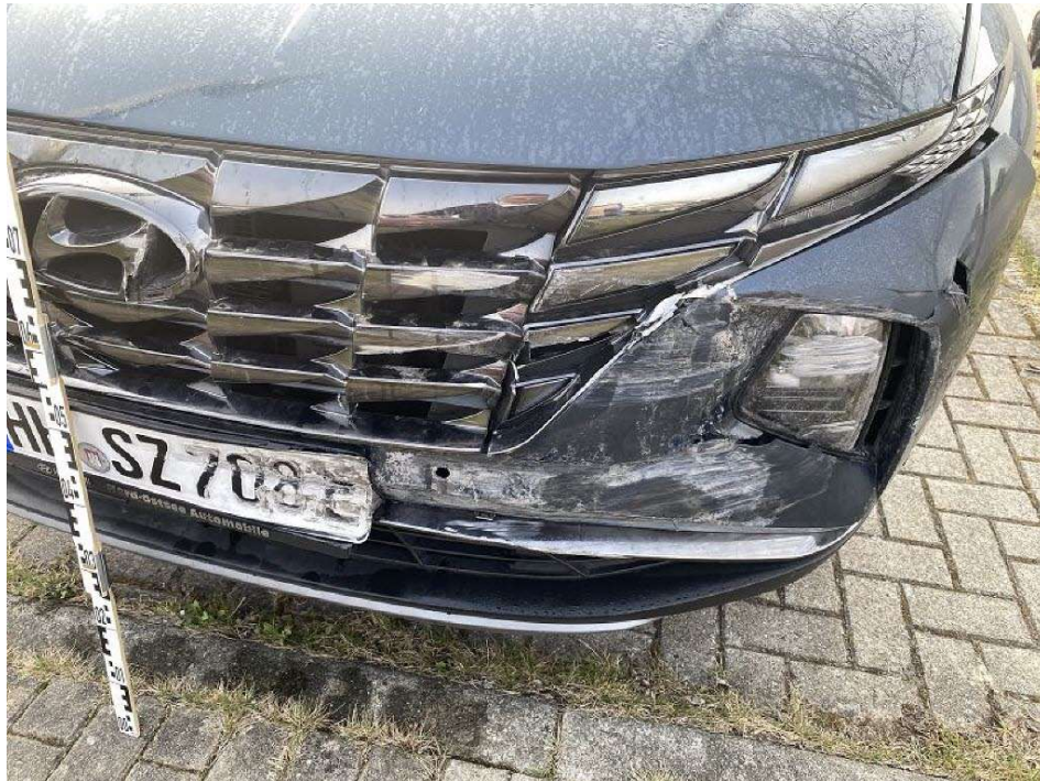
Bild 7 Übersicht Schadenbereich Fahrzeugfront im Detail
