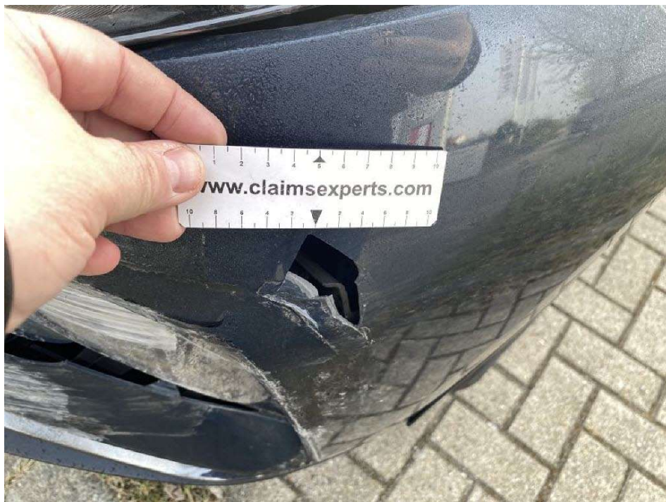
Bild 8 Stoßfängerverkleidung vorne gebrochen
