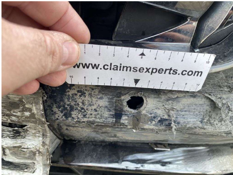
Bild 13 Einparksensor vorne links innen gebrochen
