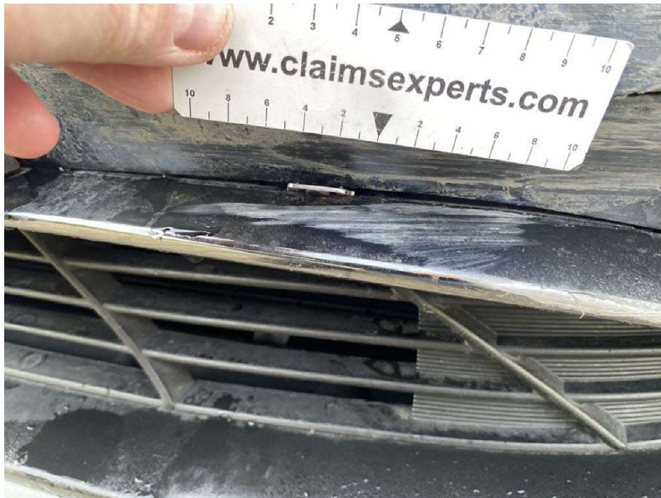
Bild 17 Zierleiste Stoßfängerverkleidung vorne kratzbeschädigt
