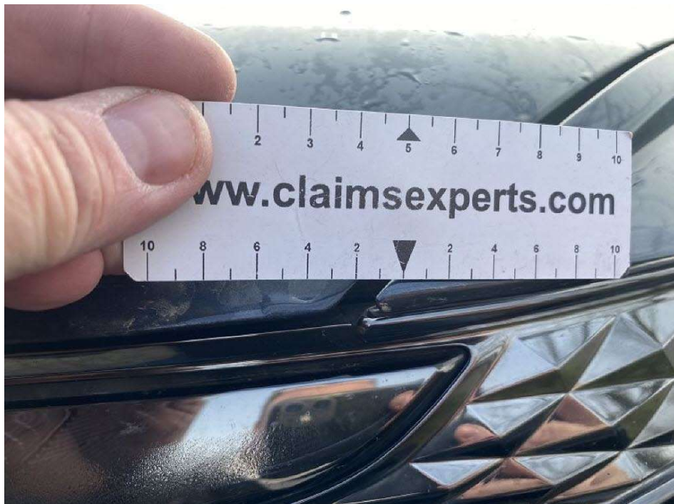
Bild 20 Kotflügel vorne links kratzbeschädigt
