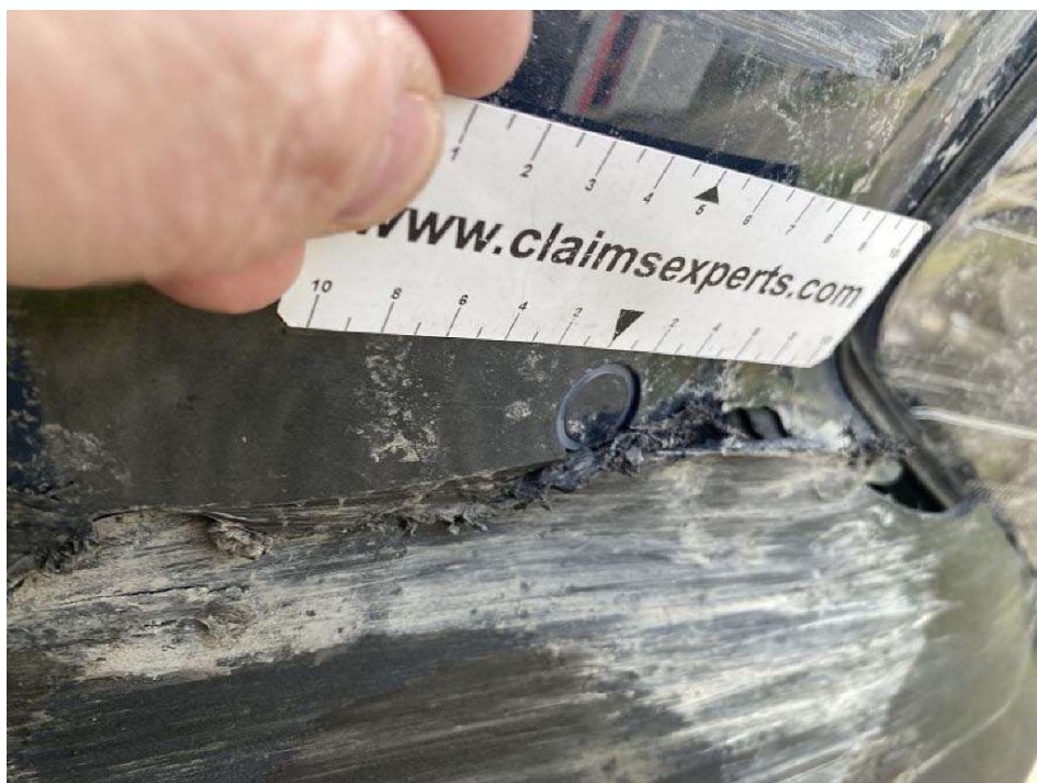
Bild 14 Einparksensor vorne links außen kratzbeschädigt
