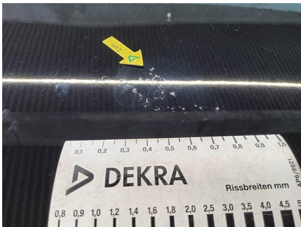
Bild 18 : Motorhaube Lackierung, Umweltschaden, lackieren mit Lackaufbau
