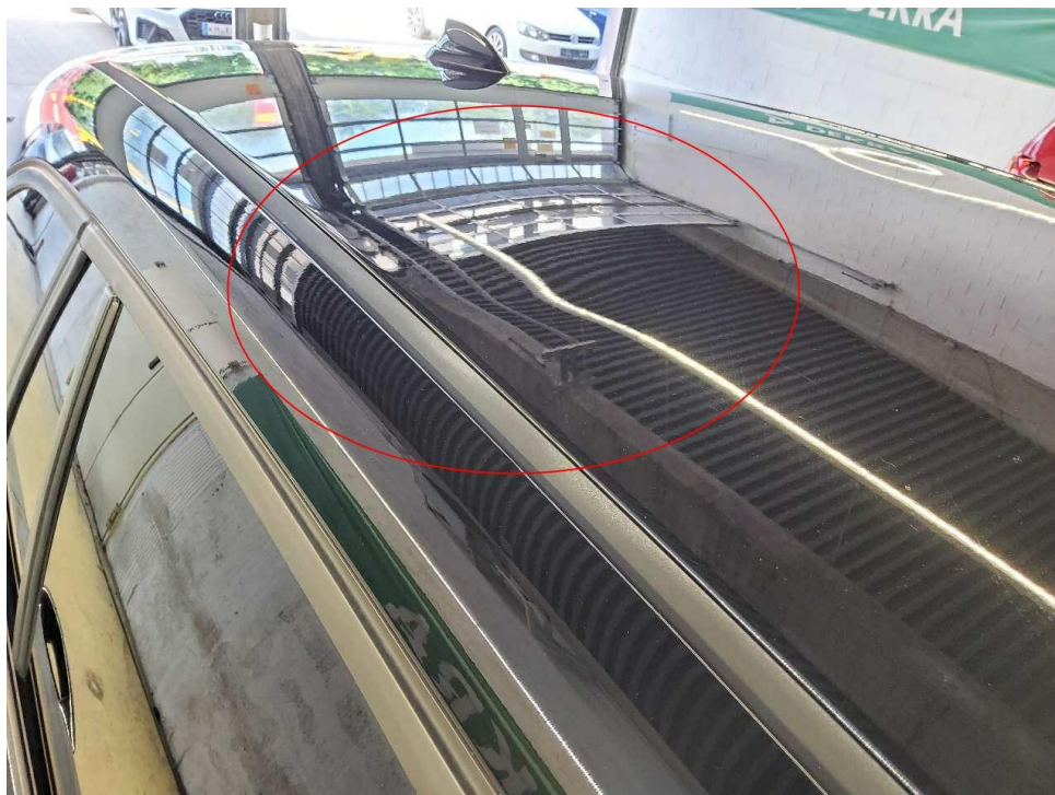
Bild 20 : Dach, mehrfach großflächig eingedellt
