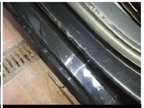
Türeinstieg / Vorne Links / Kratzer
