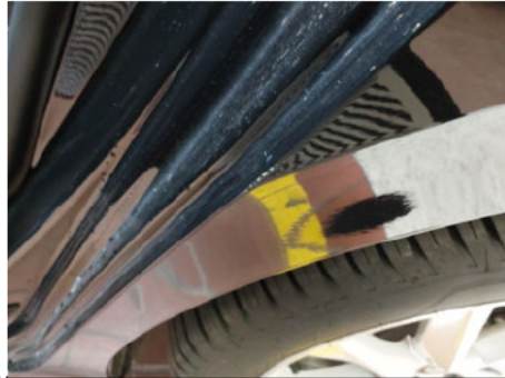
Kotflügel / Hinten Links / Kratzer
