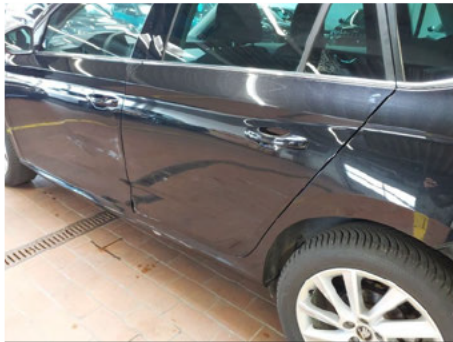
Tür / Hinten Links / Delle
