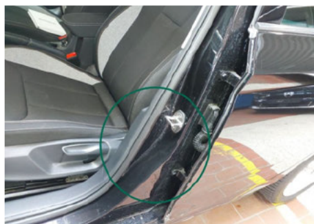
Türdichtung / Vorne Links / Abgewetzt
