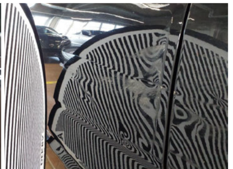
Tür / Vorne Links / Delle
