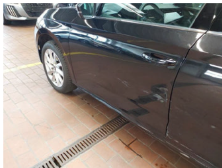
Tür / Vorne Links / Delle
