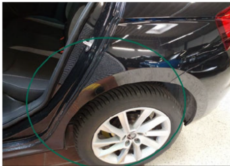
Kotflügel / Hinten Links / Kratzer
