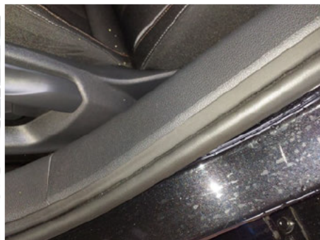
Türdichtung / Vorne Links / Abgewetzt
