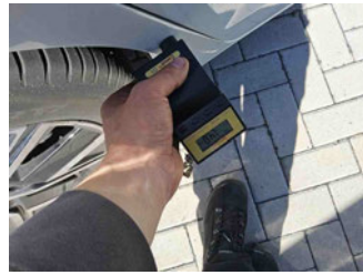
Lackstärke Seitenwand hinten rechts
