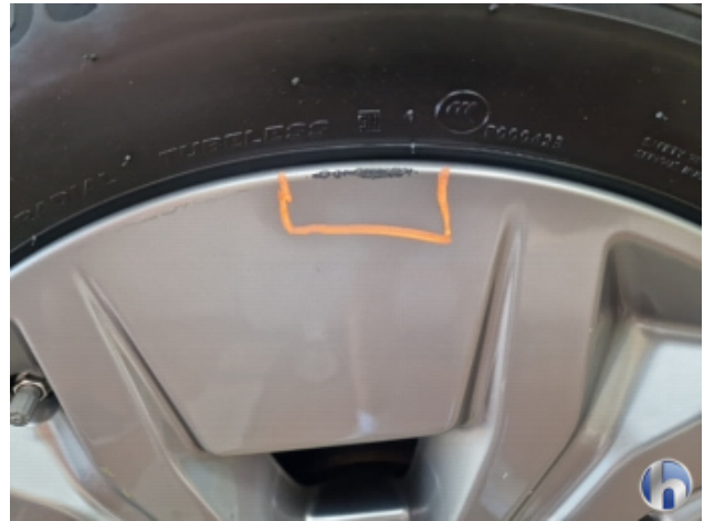
1. Felge Hinten - Rechts Beschädigt - Smart Repair
