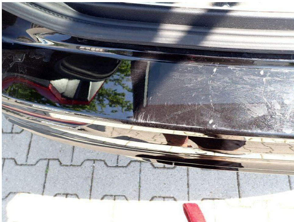
Bild 15 : Ladekante hinten Kratzer
