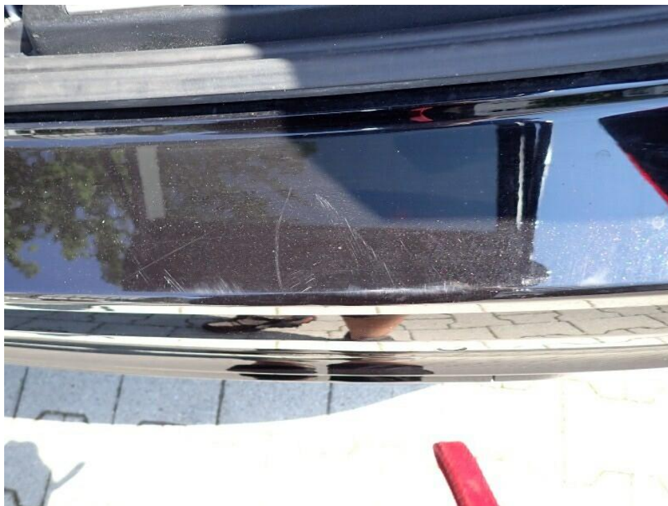
Bild 14 : Ladekante hinten Kratzer
