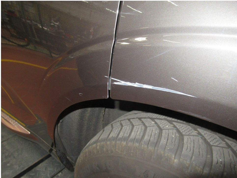
Bild 18 : Tür hinten links Lackierung, verschrammt, lackieren mit Lackaufbau Seitenteil hinten links Lackierung, verschrammt, lackieren mit Lackaufbau
