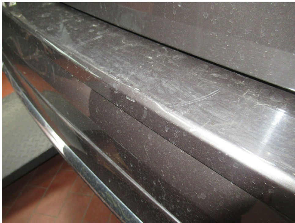
Bild 16 : Stoßfänger hinten Lackierung, zerkratzt, lackieren mit Lackaufbau
