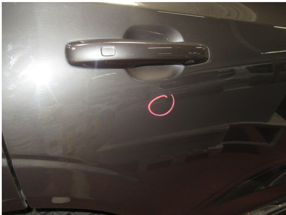
Bild 15 : Tür hinten rechts, eingedellt, drücken
