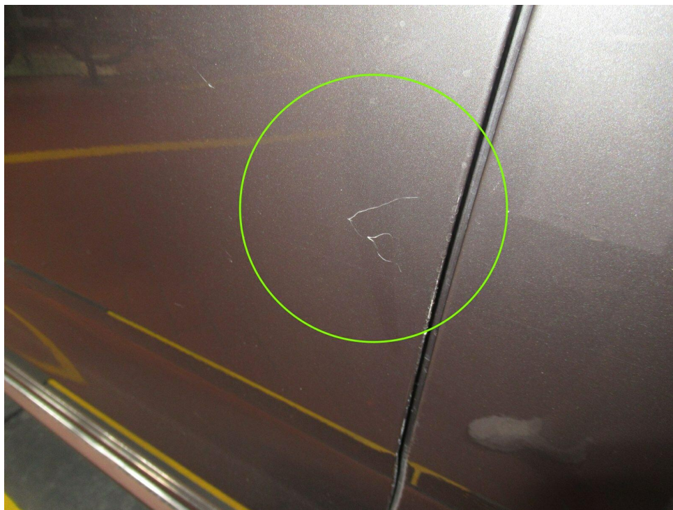
Bild 9 : Tür vorne links Lackierung, zerkratzt, lackieren mit Lackaufbau
