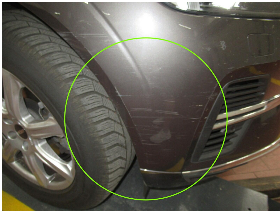
Bild 10 : Stoßfänger vorne Lackierung, verschrammt, lackieren mit Lackaufbau
