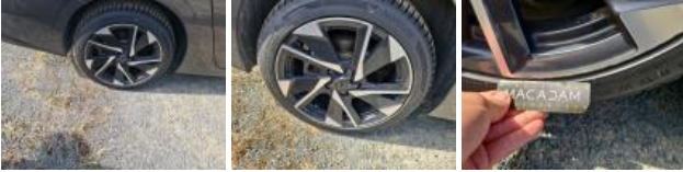
Alloy rim FL bitone/polychrome, Scratch(es), Repair/replace (lump sum)
