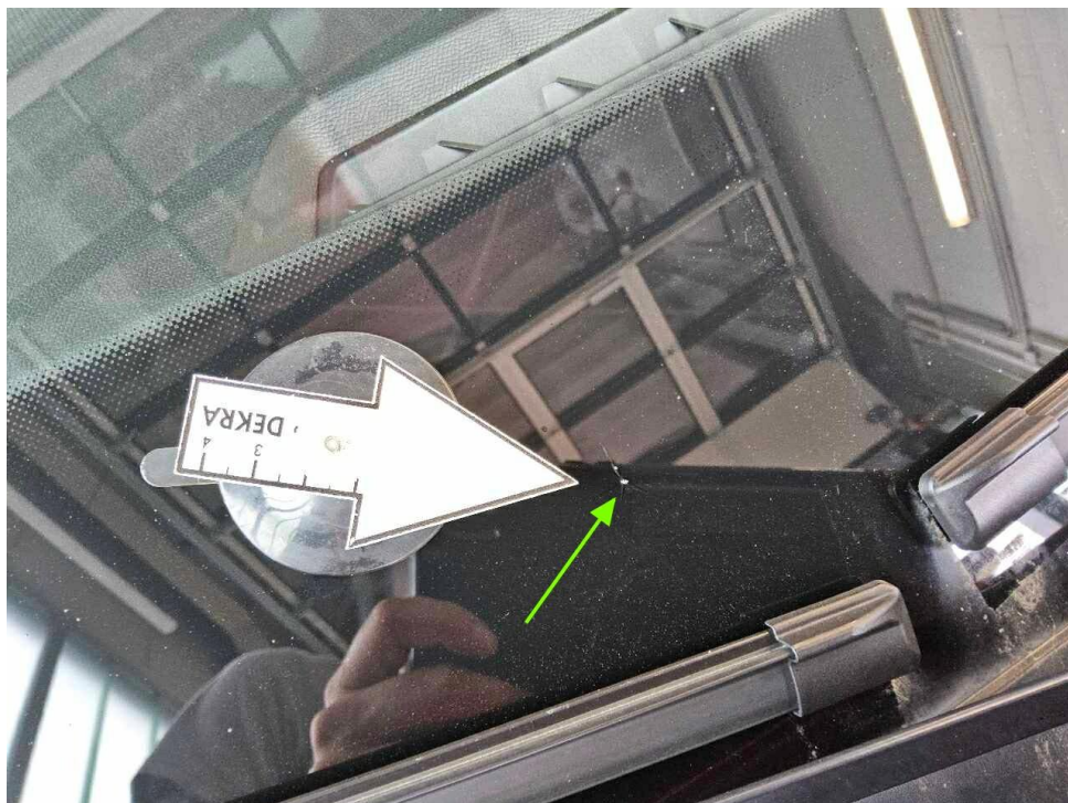
Bild 18 : Windschutzscheibe Steinschlag mit Rissbildung
