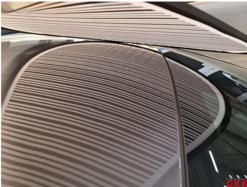
Bild 16 Fahrzeug, Hagelschaden, kalt drücken
