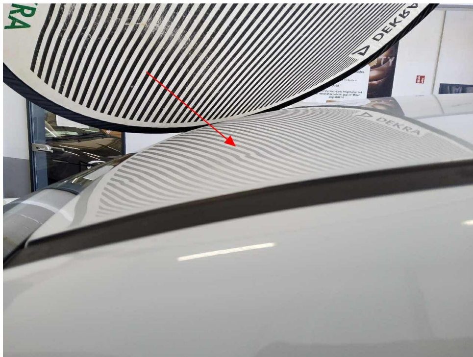
Bild 11 : Dach, mehrfach eingedellt
