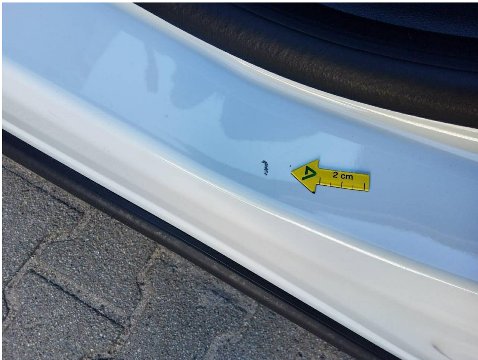
Bild 10 : Einstieg vorne links, Lackierung zerkratzt
