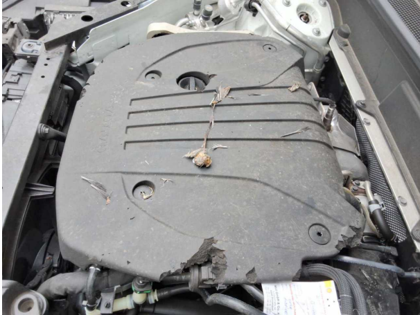
Beschädigung #2: Motor: Motorabdeckung - beschädigt - erneuern
