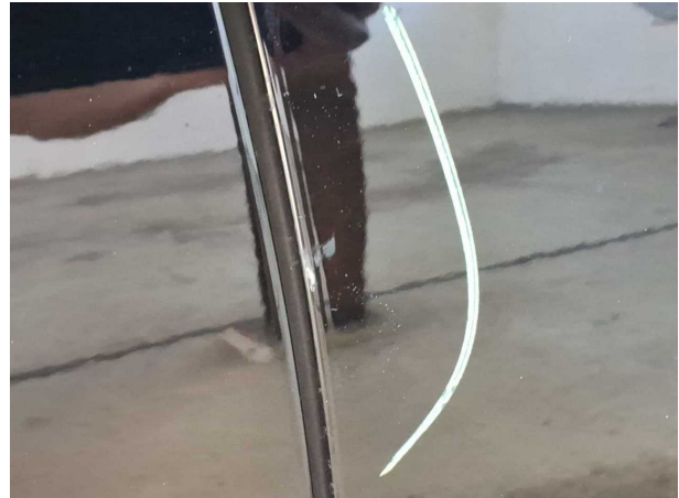
Beschädigung #2: Tür vorn rechts: Türkante - verkratzt / verschürft - auslegen / polieren
