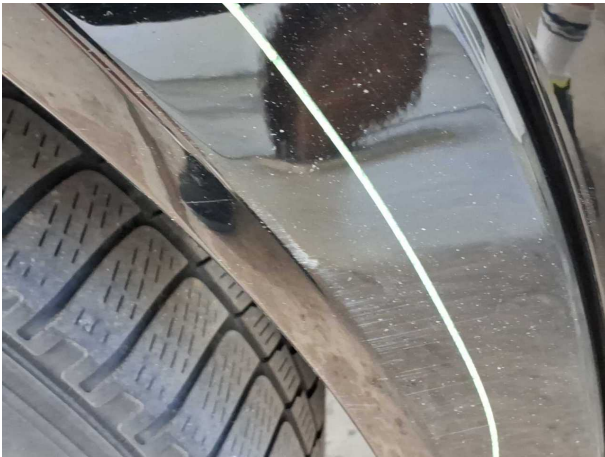
Beschädigung #6: Seitenwand rechts: Radhausverbreiterung - verkratzt / verschürft - Smart Repair
