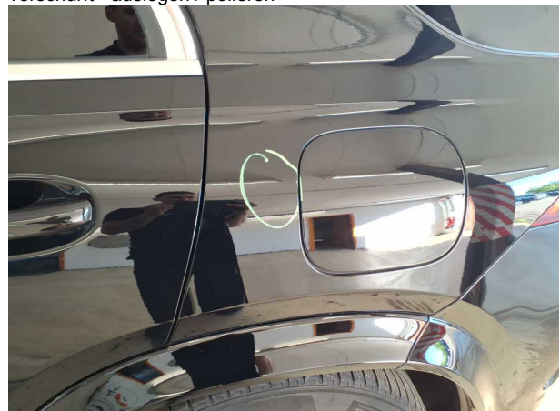
Beschädigung #4: Seitenwand links: Seitenwand - Delle(n) - sanft instandsetzen
