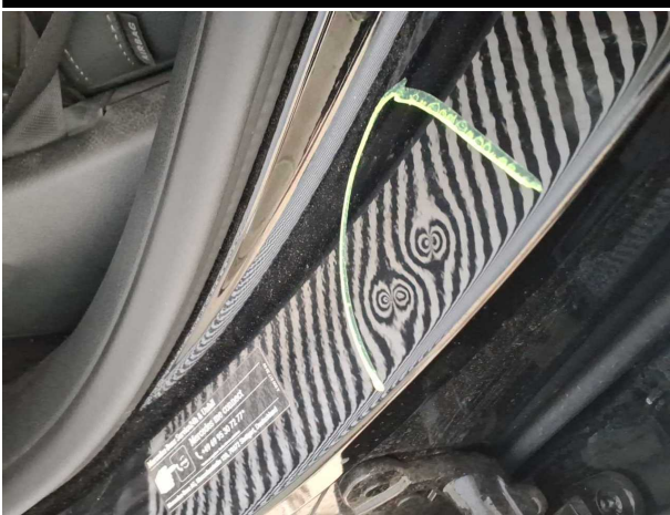
Beschädigung #5: Schweller links: Einstieg - Delle(n) - sanft instandsetzen
