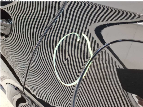
Beschädigung #4: Seitenwand links: Seitenwand - Delle(n) - sanft instandsetzen
