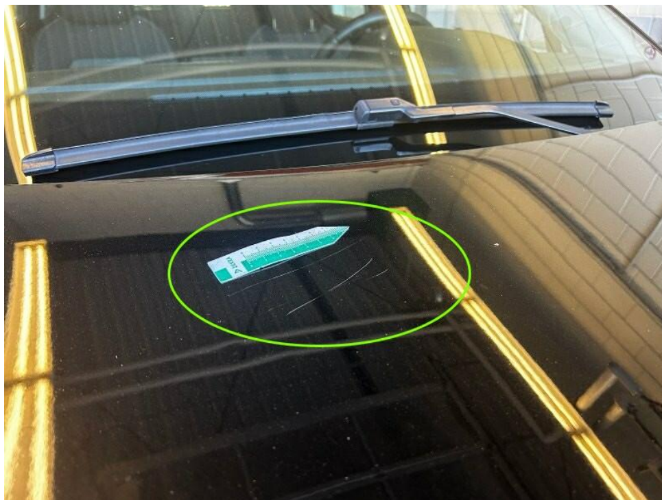
Bild 13 : Motorhaube Lackierung, zerkratzt, lackieren mit Lackaufbau
