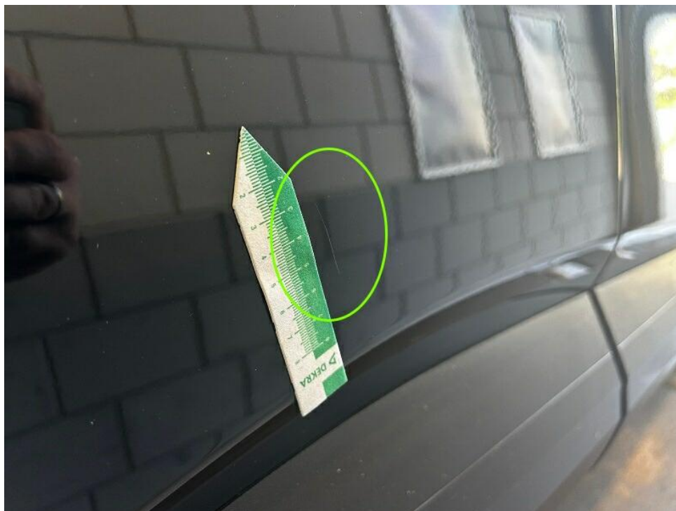
Bild 21 : Tür hinten rechts Lackierung, zerkratzt, Gebrauchsspur
