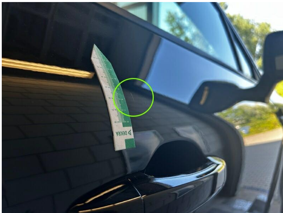
Bild 22 : Tür vorne rechts Lackierung, zerkratzt, Gebrauchsspur
