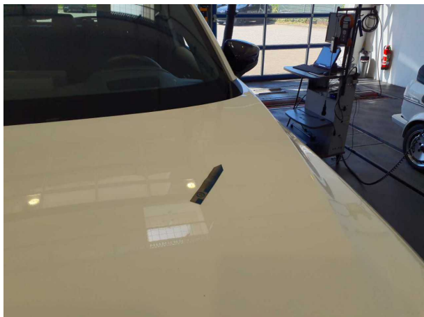
Beschädigung #1: Motorhaube: Motorhaube - Delle(n) - sanft instandsetzen
