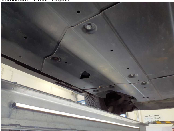
Beschädigung #3: Karosserie: Unterbodenverkleidung - gebrochen / gerissen - erneuern
