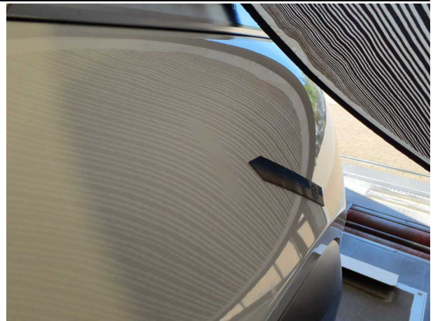
Beschädigung #7: Seitenwand links: Seitenwand (Umwelteinfluss Vogelkot) - Lackmangel - lackieren
