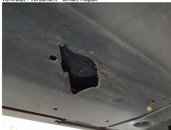
Beschädigung #3: Karosserie: Unterbodenverkleidung - gebrochen / gerissen - erneuern
