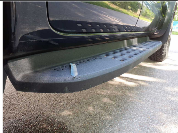
Beschädigung #6: Schweller rechts: Trittbrett - beschädigt - erneuern
