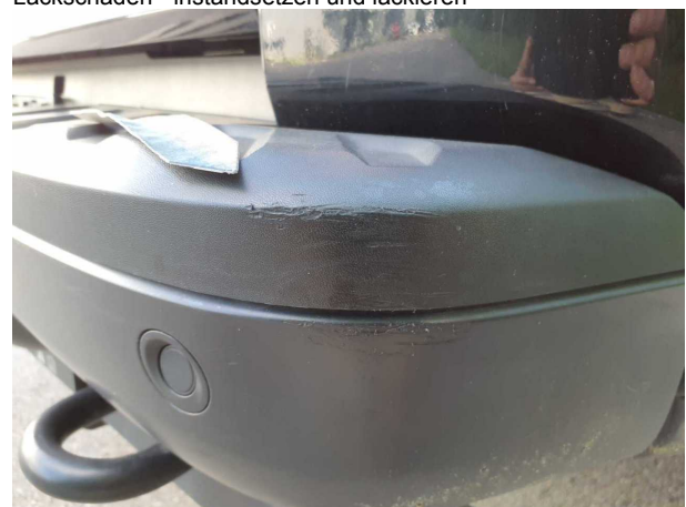
Beschädigung #10: Stossfänger hinten: Stossfänger hinten (inklusive untere Verkleidung erneuern) - beschädigt - erneuern
