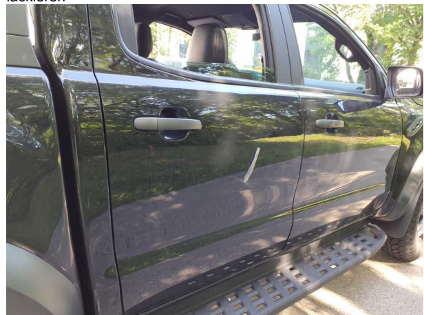
Beschädigung #8: Tür hinten rechts: Tür (Druckstelle) - verkratzt / verschürft - instandsetzen und lackieren
