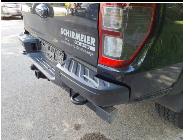
Beschädigung #10: Stossfänger hinten: Stossfänger hinten (inklusive untere Verkleidung erneuern) - beschädigt - erneuern
