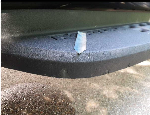
Beschädigung #6: Schweller rechts: Trittbrett - beschädigt - erneuern
