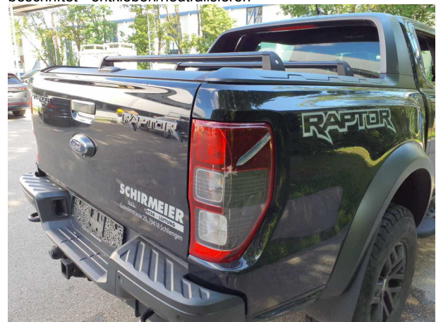
Beschädigung #4: Heckleuchte: Heckleuchte rechts - gebrochen / gerissen - erneuern
