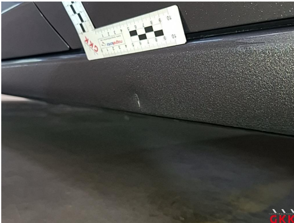
Bild 20 Schweller links, beschädigt, instand setzen - lackieren
