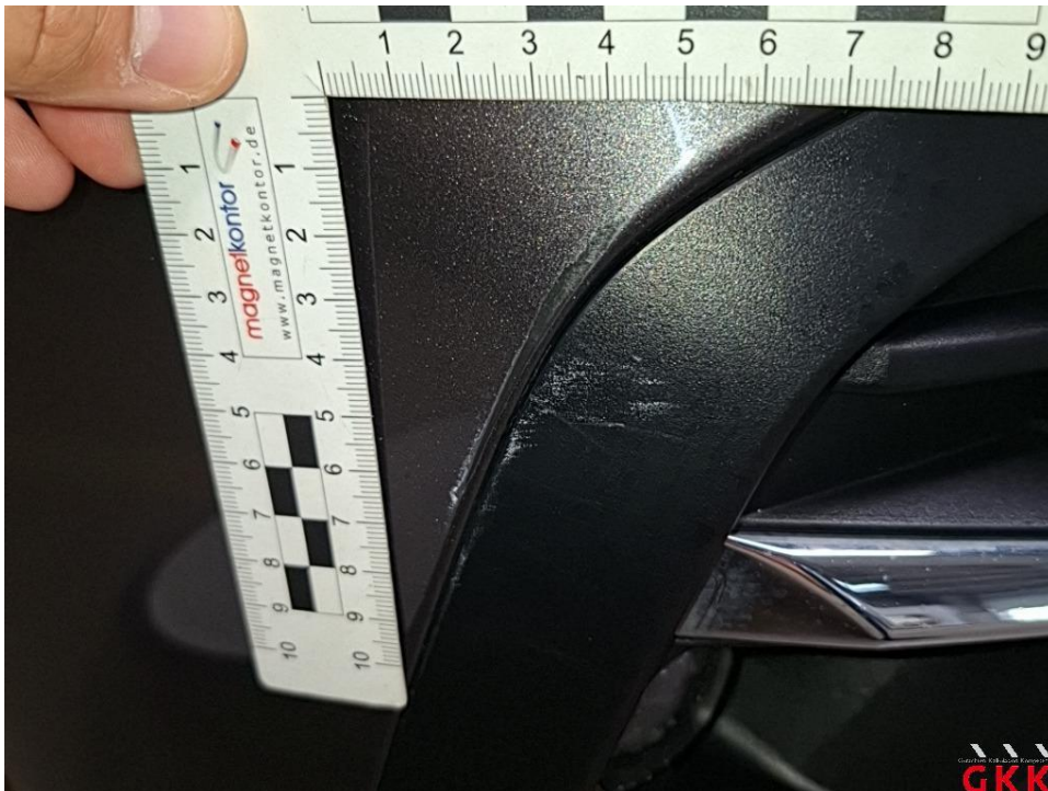
Bild 24 Fahrzeug, Seite rechts, Unfallschaden, instand setzen
