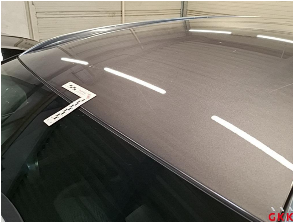
Bild 15 Dach, beschädigt, instand setzen - lackieren
