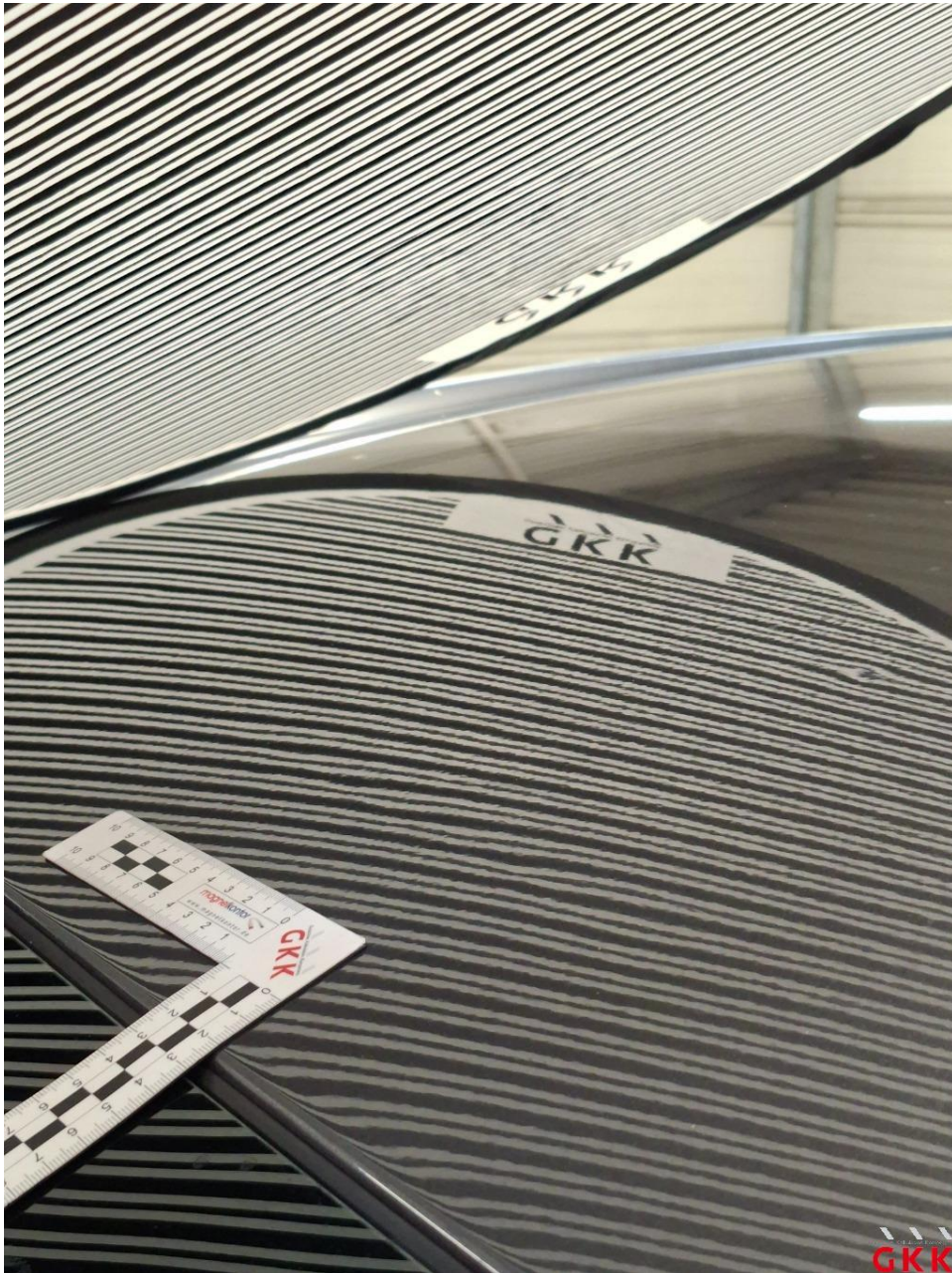
Bild 16 Dach, beschädigt, instand setzen - lackieren
