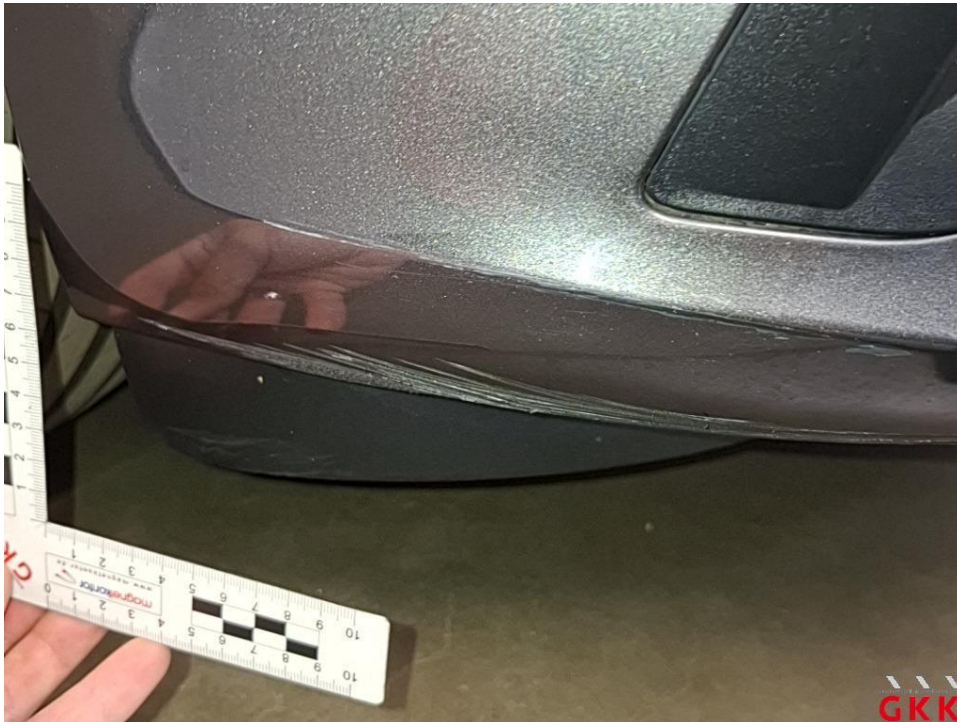
Bild 25 Fahrzeug, Seite rechts, Unfallschaden, instand setzen
