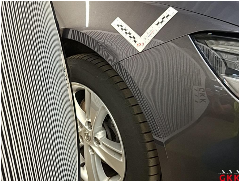
Bild 26 Fahrzeug, Seite rechts, Unfallschaden, instand setzen
