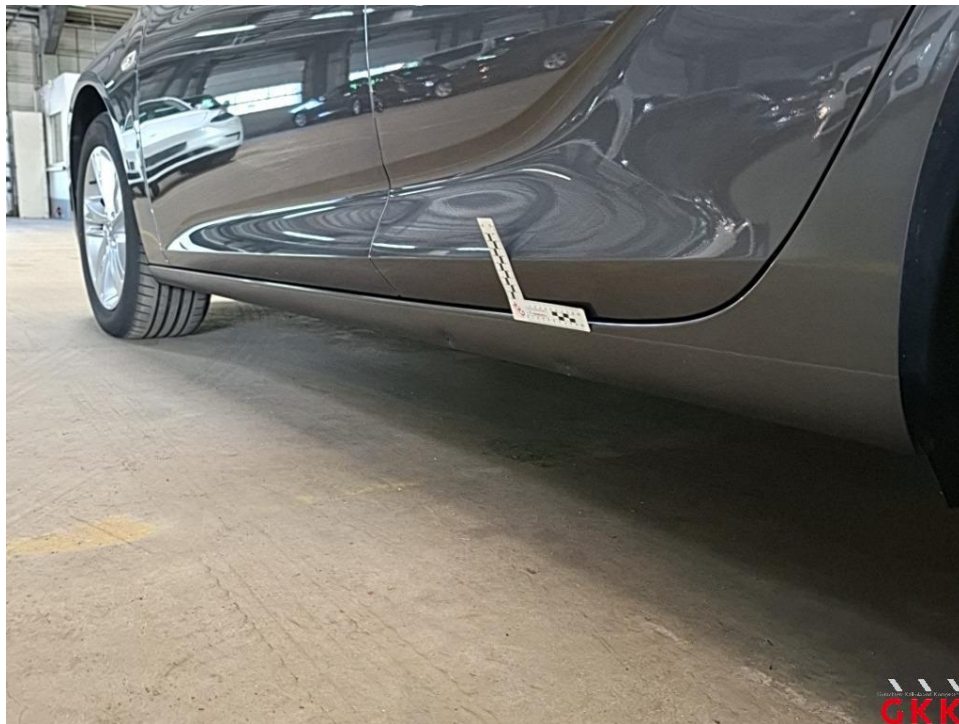
Bild 18 Schweller links, beschädigt, instand setzen - lackieren
