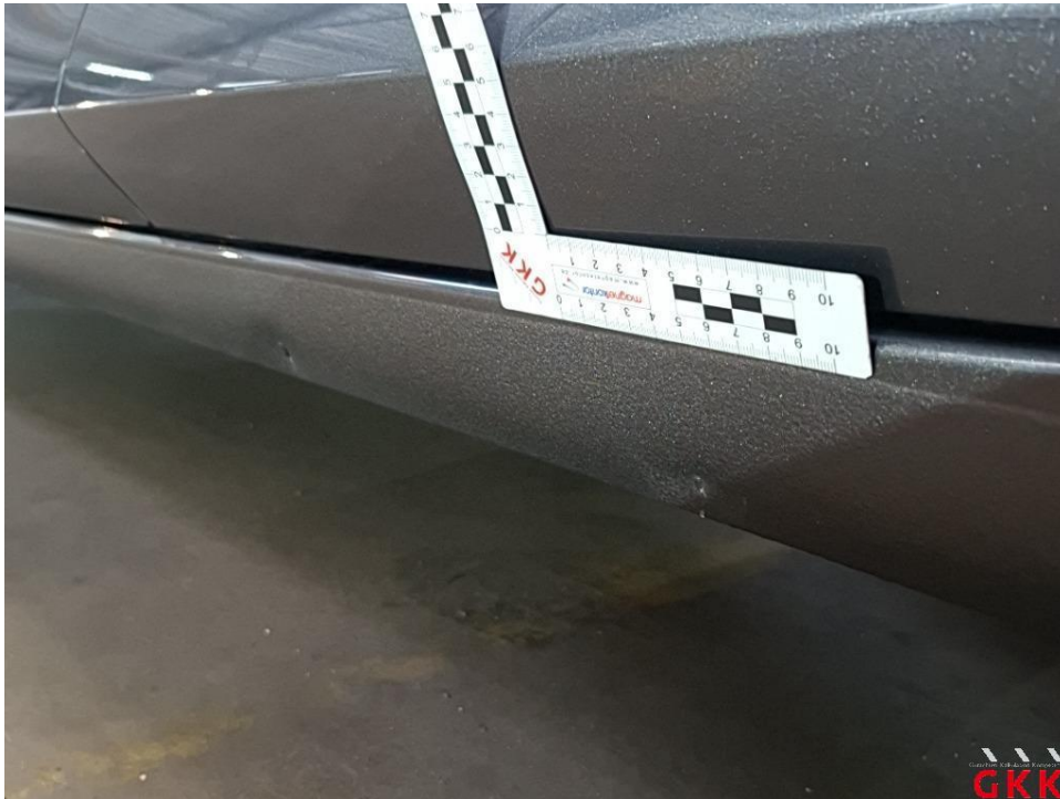
Bild 19 Schweller links, beschädigt, instand setzen - lackieren
