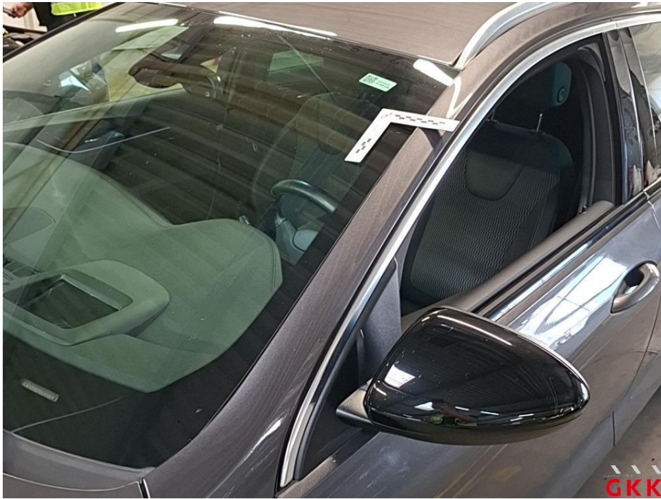
Bild 21 Frontscheibe, beschädigt, ersetzen
