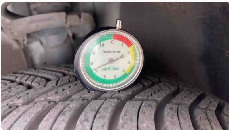
Photo mesure usure pneu avant droit
