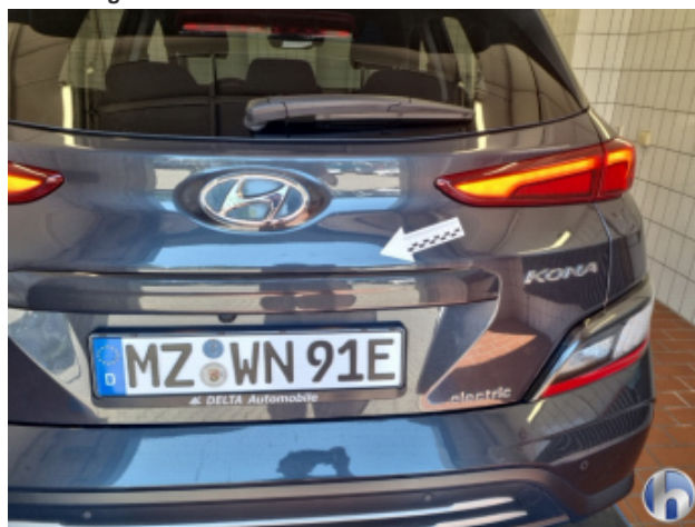
2. Heckklappe 1 Delle - Sanft Instandsetzen
