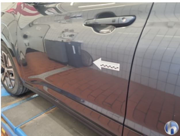
1. Tür Vorne - Links Beschädigt - Instandsetzen und Lackieren
