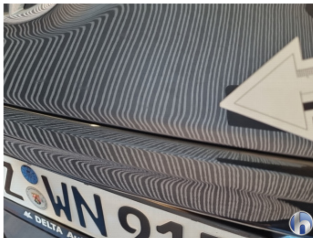
2. Heckklappe 1 Delle - Sanft Instandsetzen
