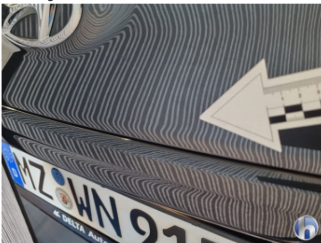
2. Heckklappe 1 Delle - Sanft Instandsetzen
