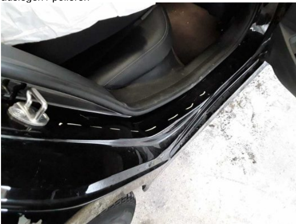
Beschädigung #3: Seitenwand rechts: Einstieg - verkratzt / verschürft - instandsetzen und lackieren
