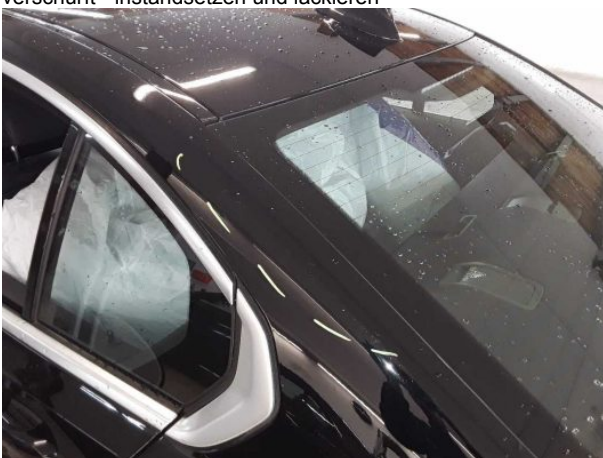
Beschädigung #4: Fahrzeugdach: Dachholm links - verkratzt / verschürft - lackieren
