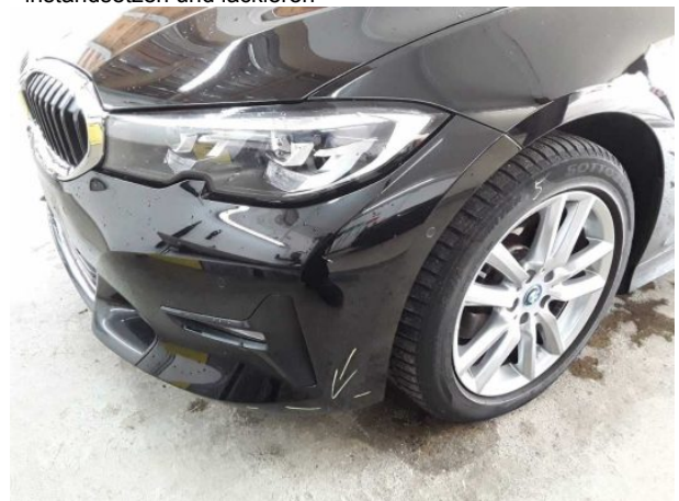
Beschädigung #8: Stossfänger vorn: Stossfänger vom - verkratzt / verschürft - instandsetzen und lackieren
