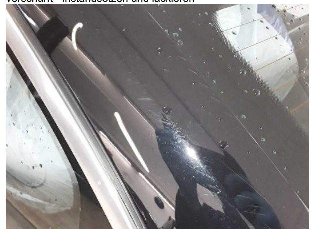
Beschädigung #4: Fahrzeugdach: Dachholm links - verkratzt / verschürft - lackieren
