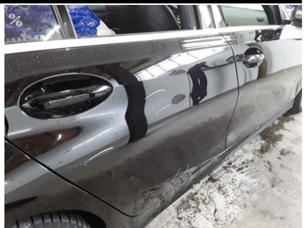
Beschädigung #7: Tür hinten rechts: Tür - verkratzt / versch... - instandsetzen und lackieren
