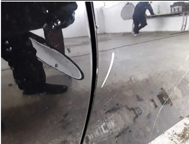
Beschädigung #9: Tür vorn rechts: Tür - verkratzt / verschürft - instandsetzen und lackieren
