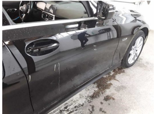
Beschädigung #9: Tür vorn rechts: Tür - verkratzt / verschürft... instandsetzen und lackieren
