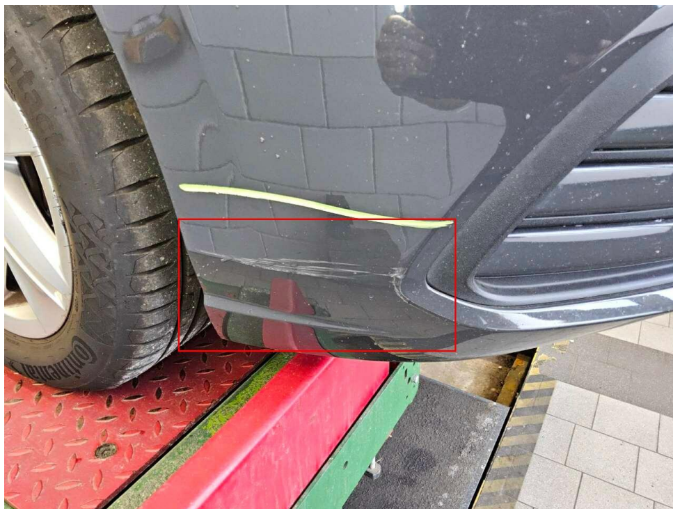
Bild 20 : Stoßfänger vorne rechts, Kratzer
