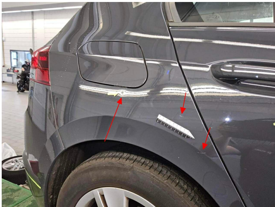
Bild 23 : Seitenteil hinten rechts, eingedellt, instandsetzen und lackieren mit Lackaufbau
