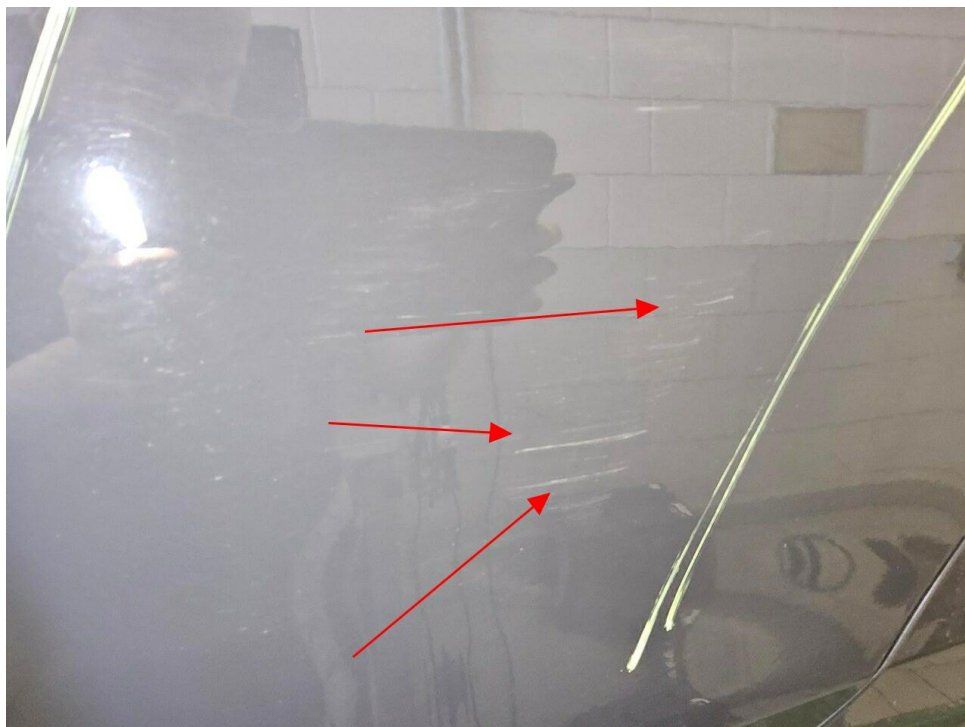
Bild 18 : Tür hinten links Lackierung, zerkratzt, lackieren mit Lackaufbau
