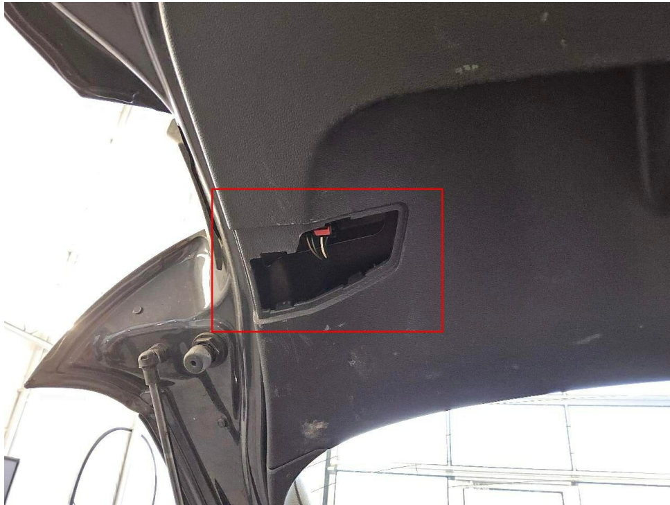
Bild 15 : Abdeckkappe Innenverkleidung Kofferraumdeckel fehlt
