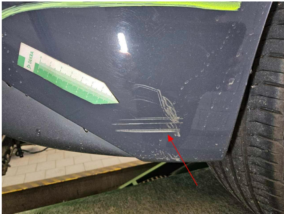
Bild 29 : Stoßfänger hinten Lackierung, verschrammt, lackieren mit Lackaufbau
