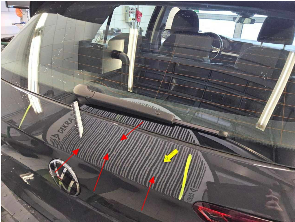
Bild 31 : Heckdeckel, mehrfach eingedellt, drücken
