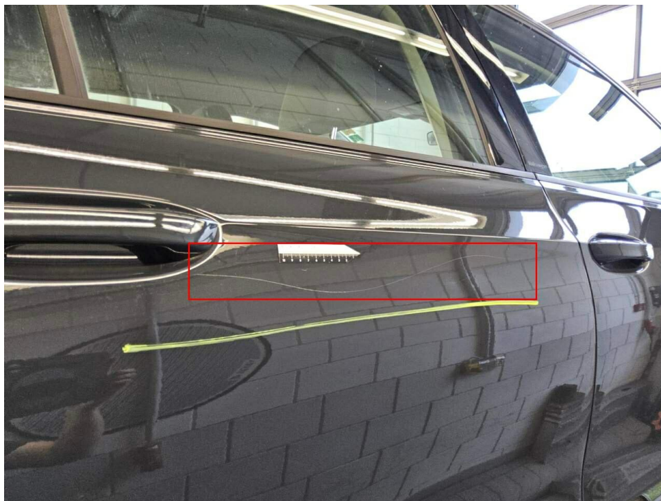
Bild 26 : Tür hinten rechts Lackierung, zerkratzt, lackieren mit Lackaufbau
