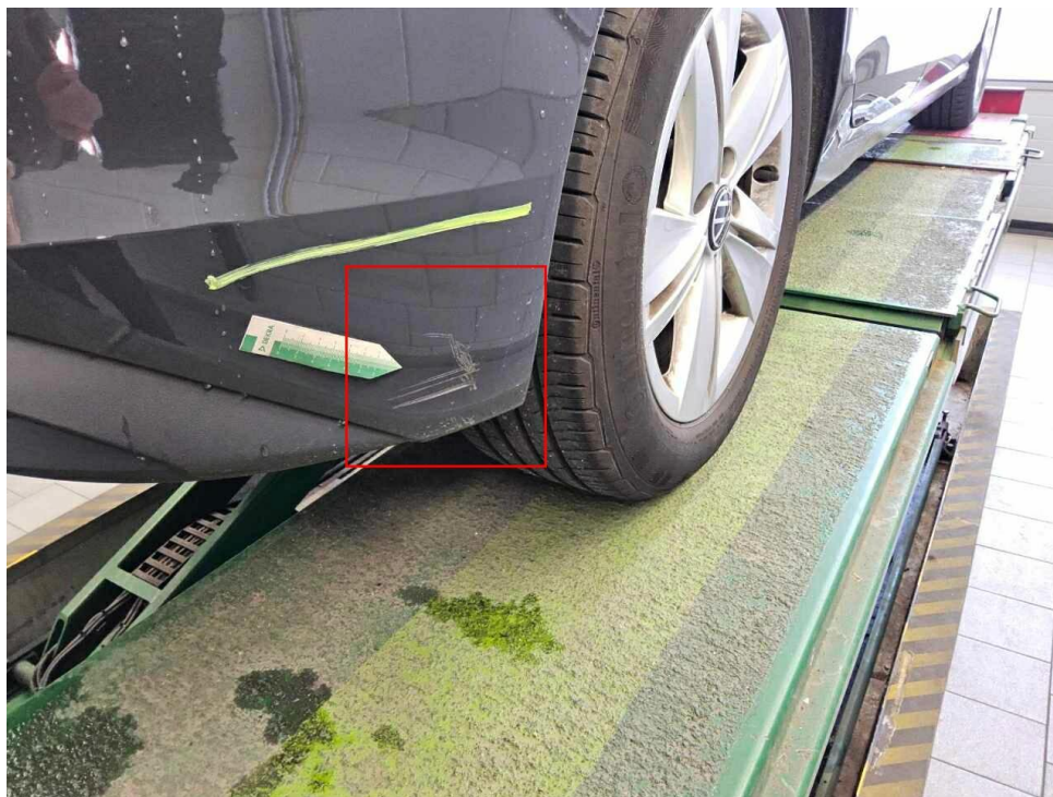
Bild 28 : Stoßfänger hinten Lackierung, verschrammt, lackieren mit Lackaufbau
