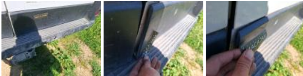
Boot door lining R, Broken, Replace
