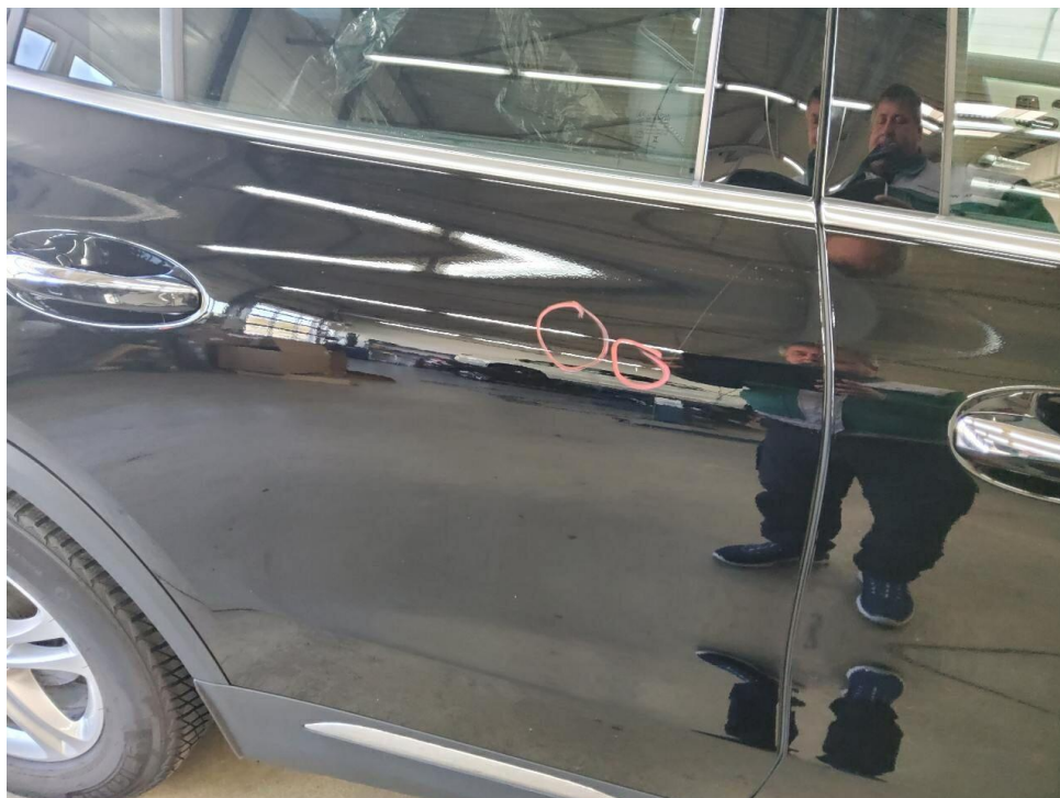
Bild 10 : Tür hinten rechts verdelit und verkratzt
